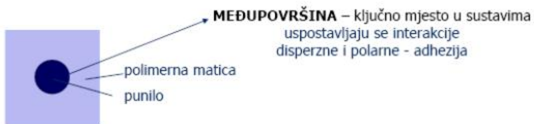
Slika 3. Prikaz međupovršine matrica - punilo
