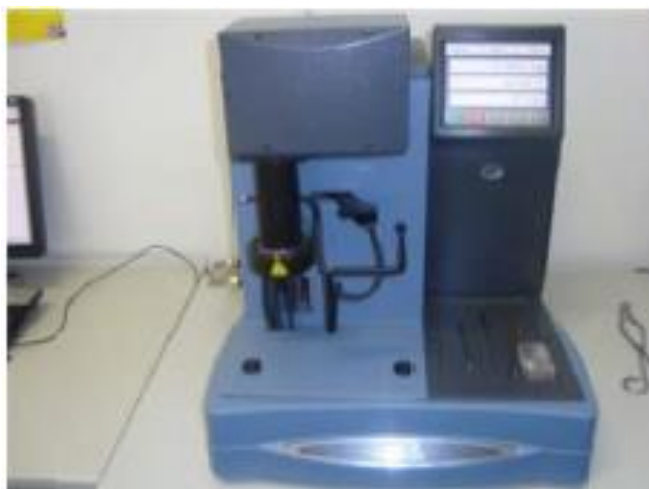
Slika 38. Termogravimetar TA Instruments Q 500
