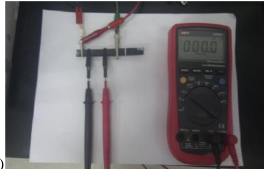
Slika 40. a) Instrument za puštanje struje određene jakosti, b) voltametar i električni krug na uzorku, spajan prema metodi četiri kontakta (slika 34.)
