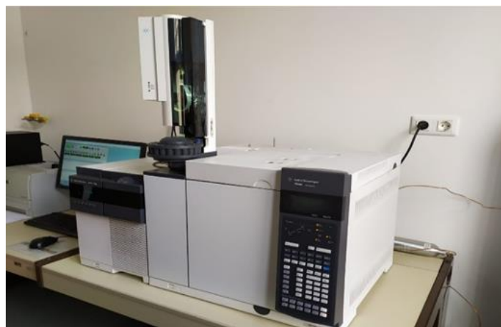
Slika 18. Plinski kromatograf sa spektrometrijom masa (GC-MS).
