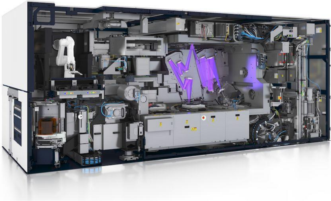
Slika 4.7.1 Kompleksni i vrlo razvijeni uređaj za obradu silikonskih ploča, čija se tehnologija bazira na radu eskimernog lasera. Cijene ovakvih uređaja kreću se oko 100 milijuna dolara. [6]
