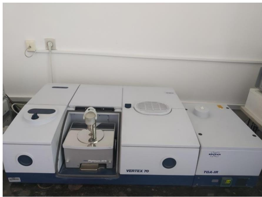
**Slika 10.** FT-IR spektrofotometar *Vertex 70, Bruker*.
