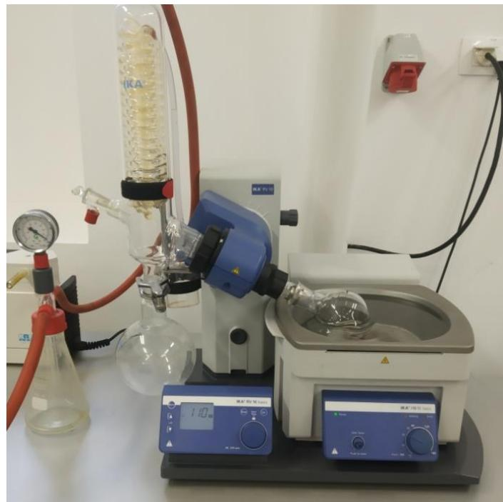
**Slika 5.** Rotacijski vakuum isparivač *IKA RV 10 basic*.
