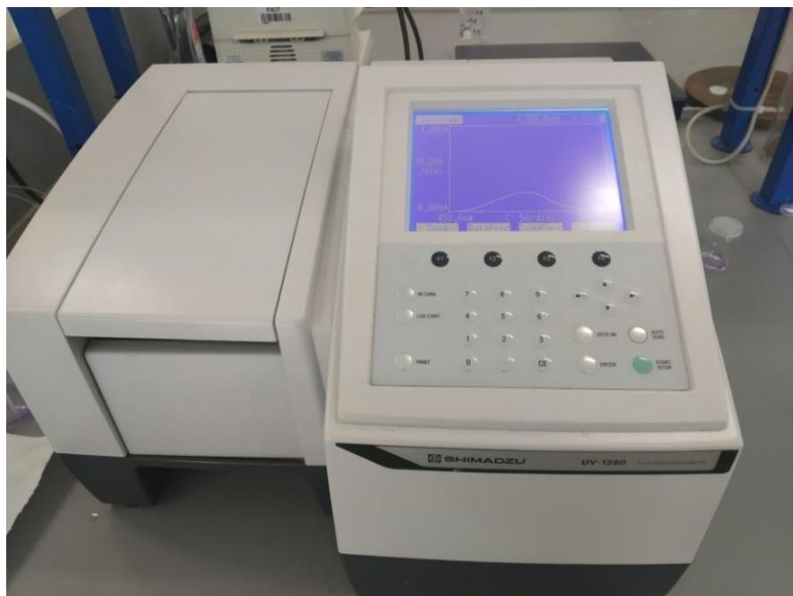
**Slika 9.** UV/VIS spektrofotometar *UV-1280, Shimadzu*.
