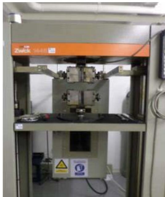
Slika 18. Kidalica UTM 1445 Zwick Röell, Njemačka.
