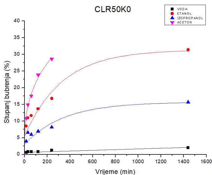
Slika 29. Ovisnosti stupnja bubrenja (u otapalima vodi, etanolu, izopropanolu i acetonu) o vremenu za epruvete od materijala Clear (CLR), debljine ispisa 50  $\mu\text{m}$ , ispisane pod 0° (K0).
