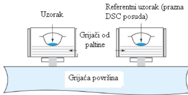
Slika 5. DSC uređaj s mogućnošću kompenzacije snage [14].
