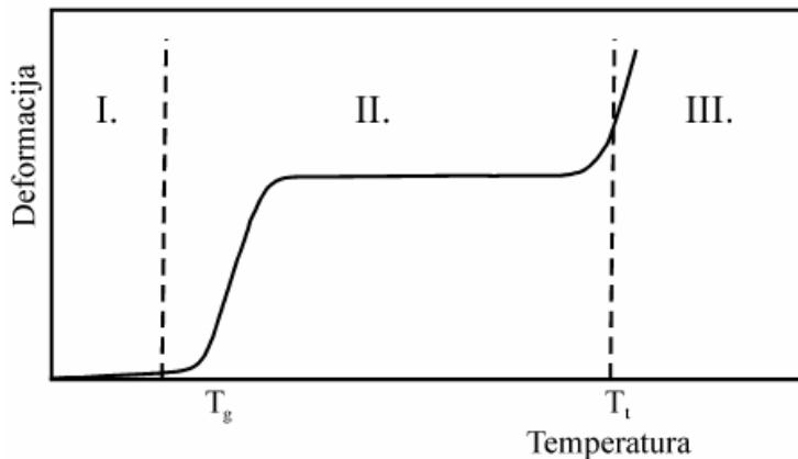
Slika 3. Termomehanička krivulja linerarnog, amorfognog polimera [9].
