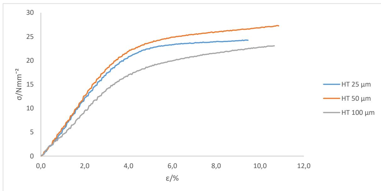
Slika 23. Grafički prikaz ovisnosti naprezanja o istezanju za epruvete ispisane pod kutom od  $0^\circ$ , za sve debljine sloja ispisa (25  $\mu\text{m}$ , 50  $\mu\text{m}$  i 100  $\mu\text{m}$ ) za materijal High Temp.
