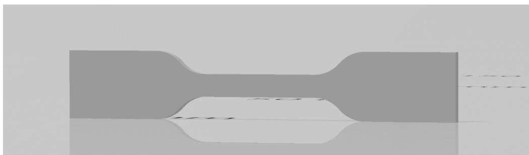
Slika 13 . Model epruvete u STL formatu.
