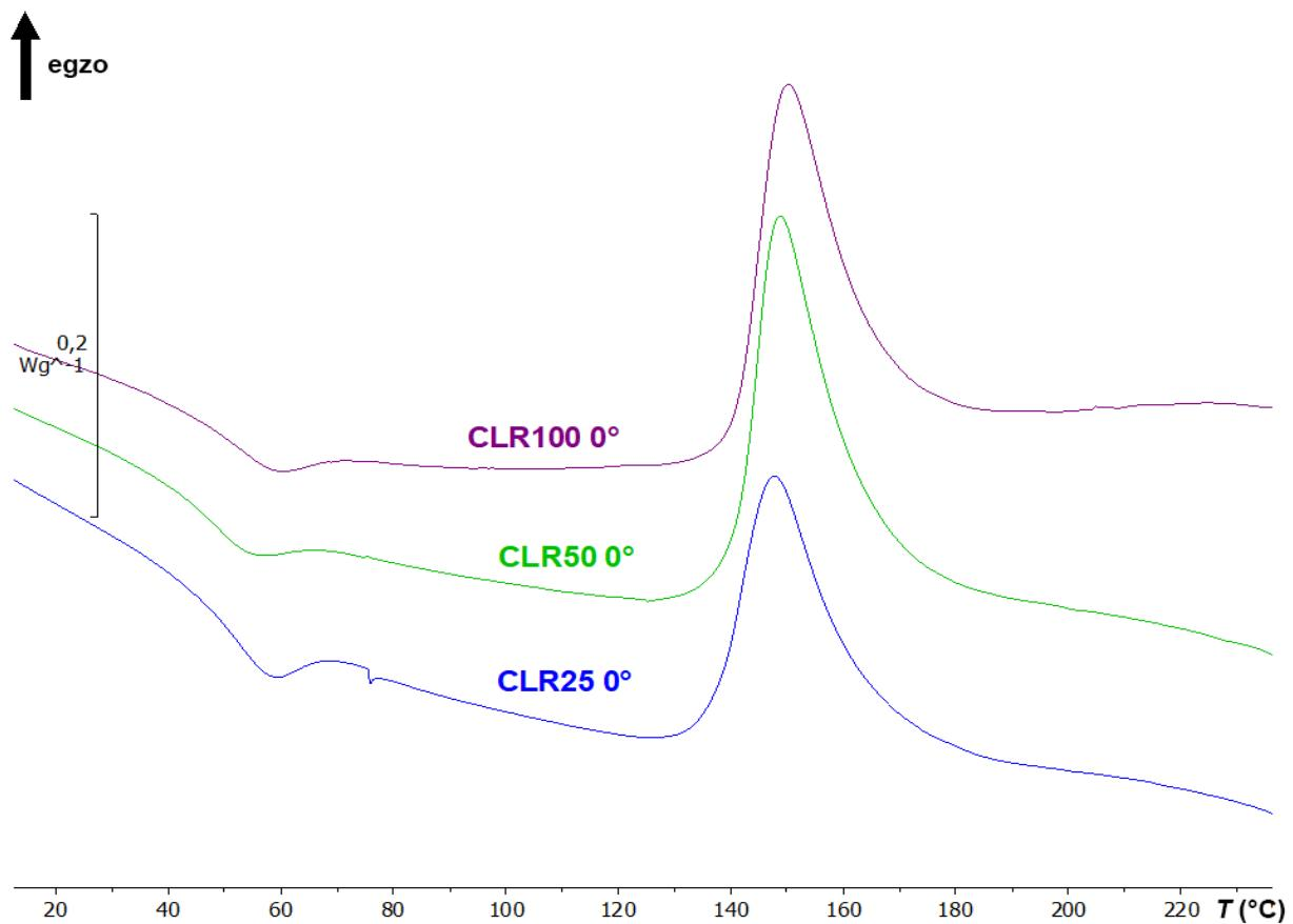
Slika 26. Termogrami zagrijavanja uzorka od smole Clear kuta ispisa  $0^\circ$ , svih debljina sloja ispisa.
