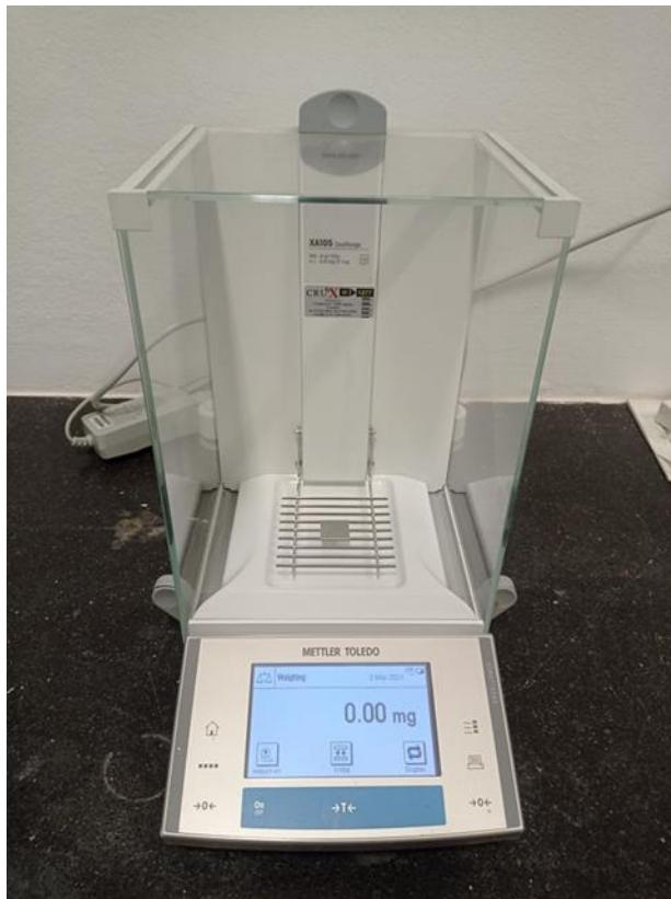
**Slika 20.** Analitička vaga XA105 DualRange, Mettler Toledo
