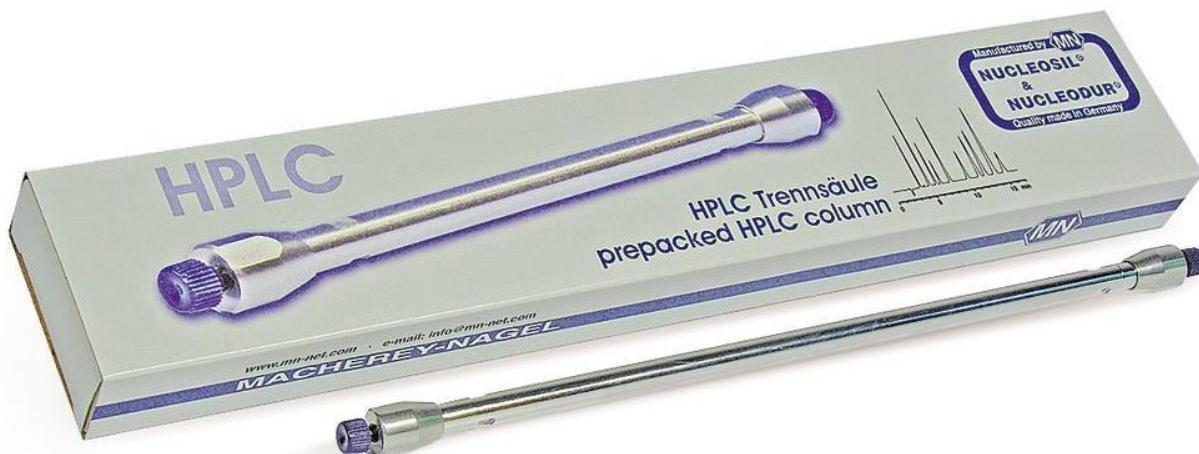
**Slika 12.** Kromatografska kolona NUCLEODUR® C18 Gravity [32]
