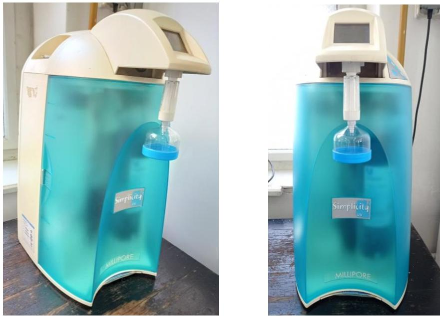
**Slika 23.** Uređaj za proizvodnju MilliQ vode, Millipore Simplicity UV
