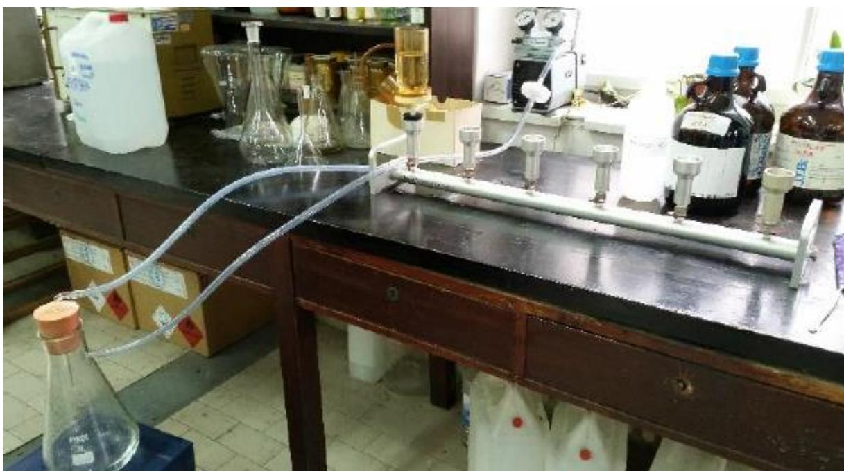
Slika 21. Uređaj za filtraciju PALL Life Sciences
