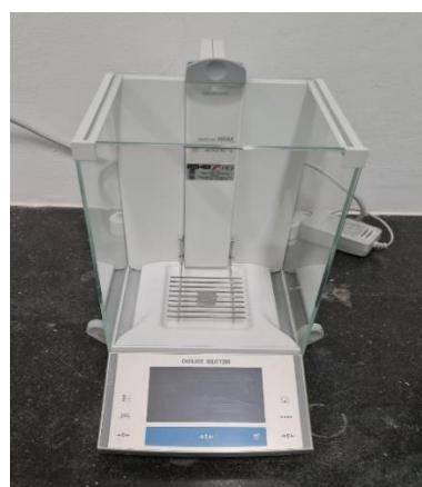
*Slika 3.2. Analitička vaga Mettler Toledo XA105 DualRange*
