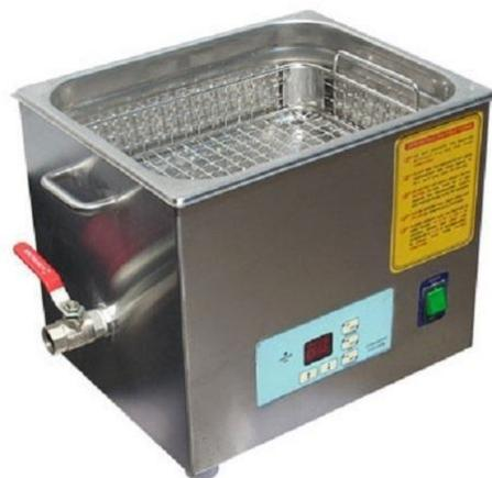
*Slika 3.5. Ultrazvučna kupelj*
