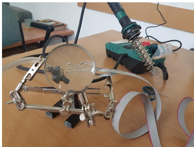
Slika 22 Lemljenje senzora tlaka
