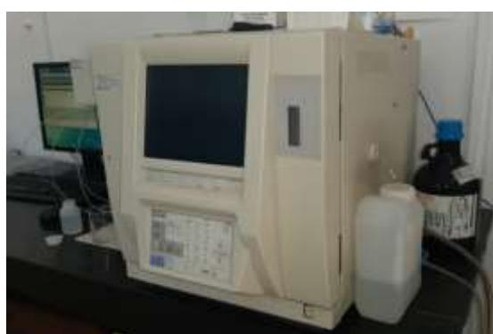
**Slika 3.** TOC analizator Shimadzu TOC-Vws (Japan)
