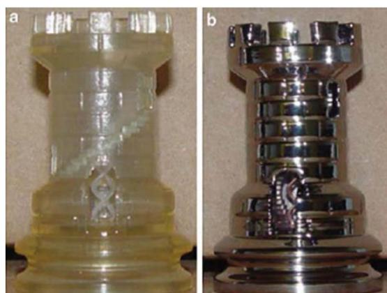
Slika 18. Predmet izrađen stereolitografijom a) prije kromiranja b) nakon postupka kromiranja [1]
