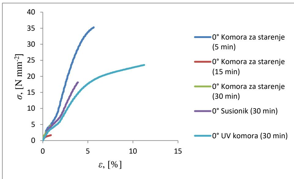
Slika 41. Grafički prikaz ovisnosti naprezanja o istezanju za epruvete ispisane pod kutom od  $0^\circ$ , nakon svih vrsta naknadnog očvršćivanja
