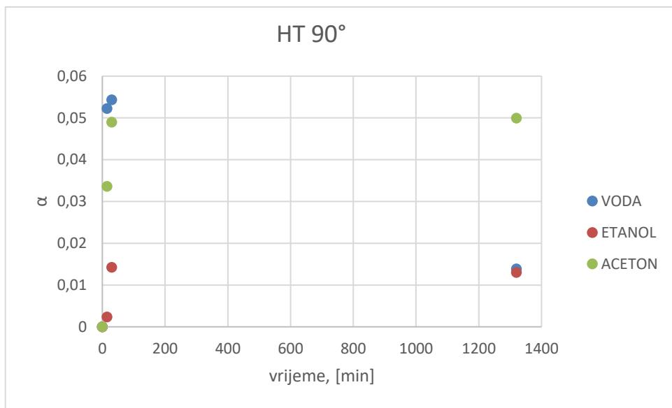
Slika 35. Grafički prikaz ovisnosti stupnja bubrenja (u otapalima vodi, etanolu i acetonu) o vremenu za epruvetu ispisano pod  $90^\circ$  (bez naknadnog očvršćivanja)
