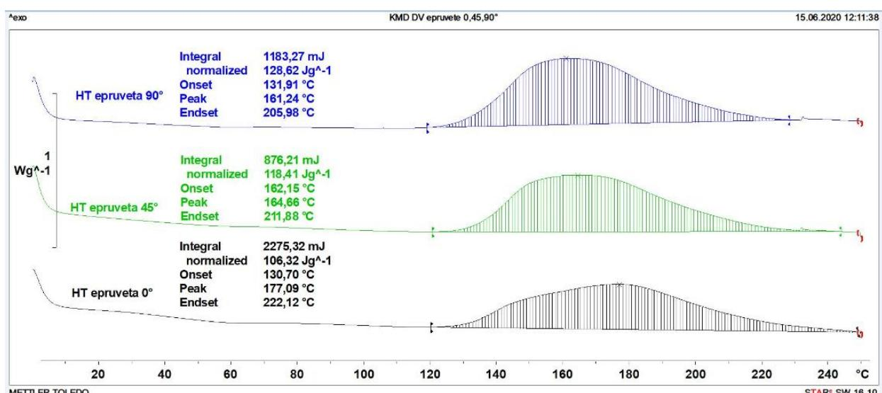
Slika 31. Termogram zagrijavanja uzorka epruveta ispisanih pod kutovima 0°, 45° i 90° (bez naknadnog očvršćivanja)
