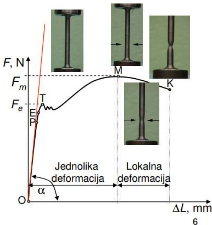
Slika 3. Dijagram ovisnosti sile o produljenju [14]
