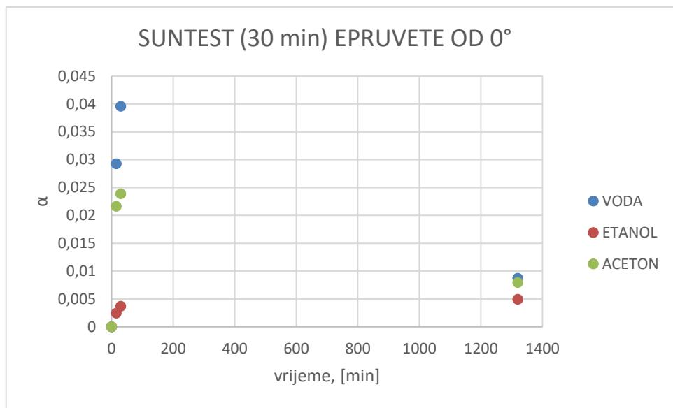
Slika 37. Grafički prikaz ovisnosti stupnja bubrenja (u otapalima vodi, etanolu i acetonu) o vremenu za epruvetu ispisani pod  $0^\circ$ , 30 minuta naknadno očvrnsnutu u komori za starenje
