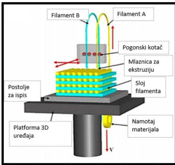
Slika 13. Shematski dijagram FFF metode aditivne proizvodnje [1]
