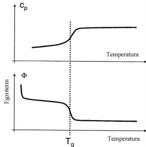
Slika 11. Prikaz određivanja temperature staklastog prijelaza DSC tehnikom [17]
