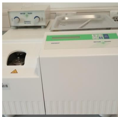
Slika 29. Uređaj Mettler Toledo DSC 823
