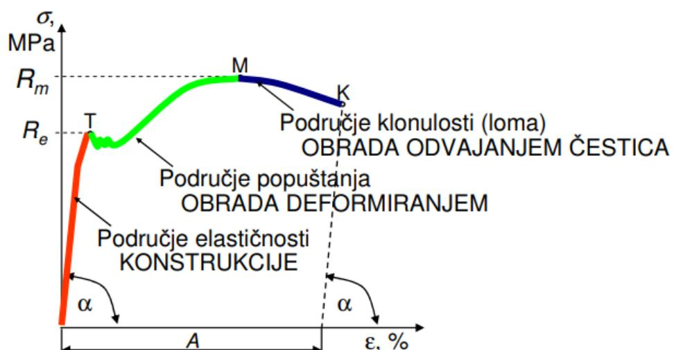
Slika 4. Grafički prikaz ovisnosti naprezanja o istezanju [14]
