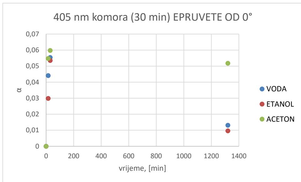
Slika 39. Grafički prikaz ovisnosti stupnja bubrenja (u otapalima vodi, etanolu i acetonu) o vremenu za epruvetuispisanu pod  $0^\circ$ , 30 minuta naknadno očvršnutu u 405 nm komori
