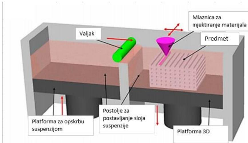
Slika 15. Shematski prikaz metode ispisa injektiranjem [1]
