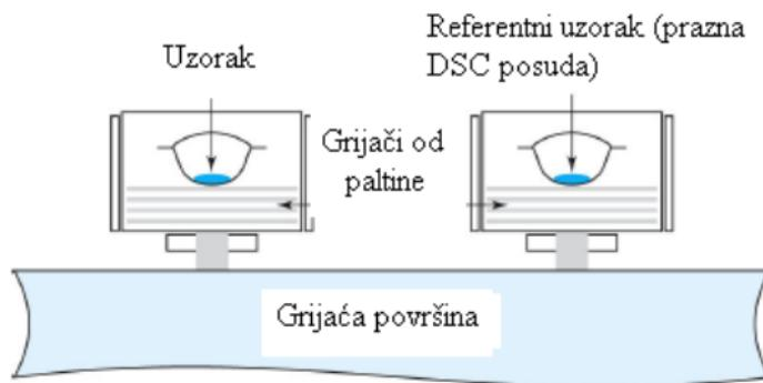
Slika 8. DSC instrument s mogućnošću kompenzacije snage [17]
