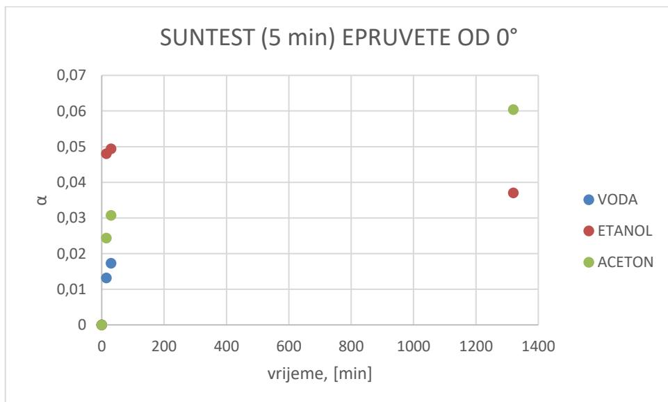
Slika 36. Grafički prikaz ovisnosti stupnja bubrenja (u otapalima vodi, etanolu i acetonu) o vremenu za epruvetu ispisano pod  $0^\circ$ , 5 minuta naknadno očvrsnuto u komori za starenje
