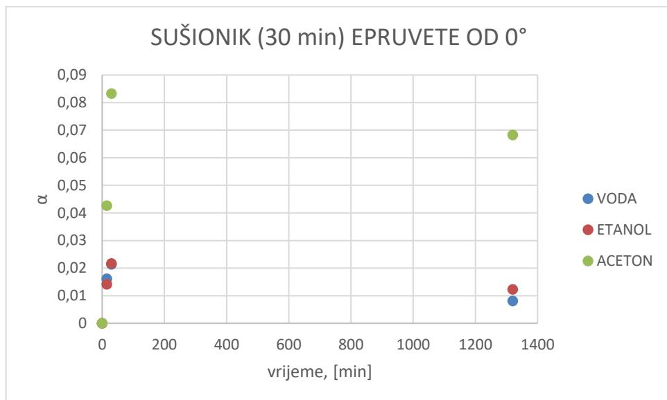
Slika 38. Grafički prikaz ovisnosti stupnja bubrenja (u otapalima vodi, etanolu i acetonu) o vremenu za epruvetu ispisani pod  $0^\circ$ , 30 minuta naknadno očvrnsnutu u sušioniku
