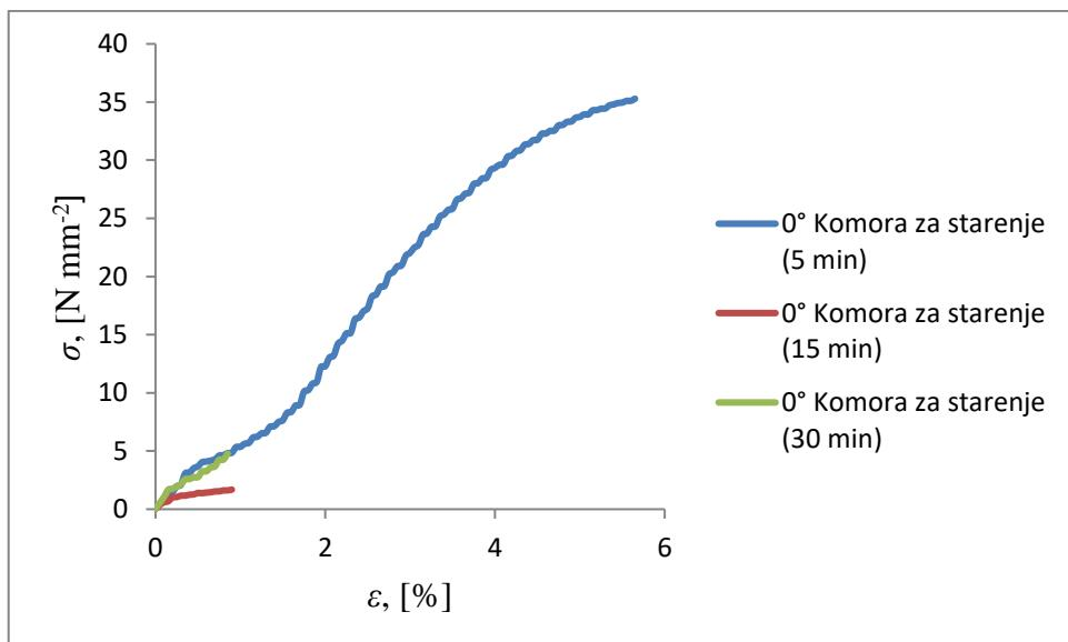
Slika 42. Grafički prikaz ovisnosti naprezanja o istezanju za epruvete ispisane pod kutom od  $0^\circ$  nakon naknadnog očvršćivanja u komori za starenje
