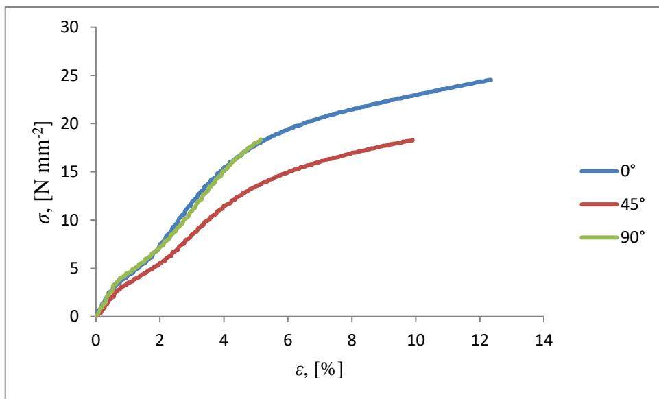
Slika 40. Grafički prikaz ovisnosti naprezanja o istezanju za epruvete ispisane pod kutovima od  $0^\circ$ ,  $45^\circ$  i  $90^\circ$ , bez naknadnog očvršćivanja
