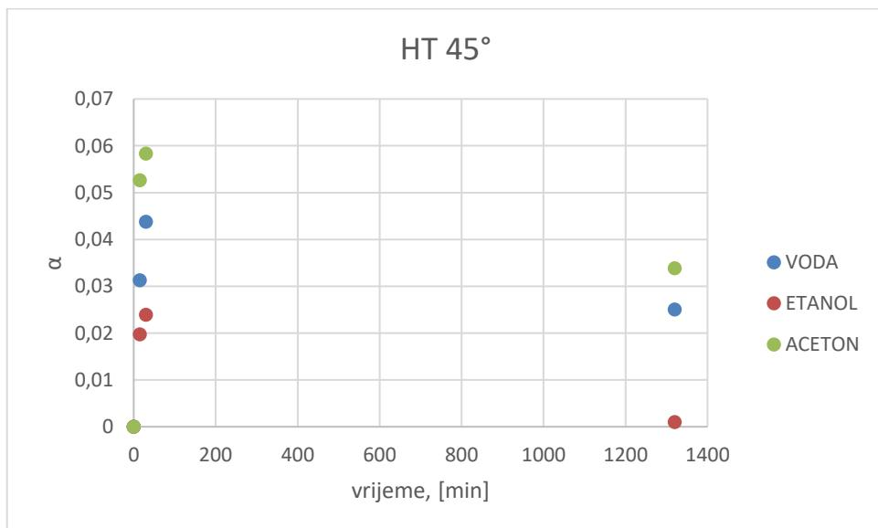
Slika 34. Grafički prikaz ovisnosti stupnja bubrenja (u otapalima vodi, etanolu i acetonu) o vremenu za epruvetu ispisano pod  $45^\circ$  (bez naknadnog očvršćivanja)
