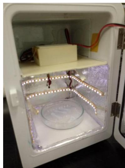
Slika 26. Naknadno očvršćivanje epruveta primjenom 405 nm komore
