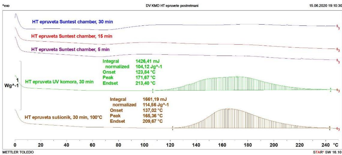
Slika 32. Termogram uzorka epruveta ispisanih pod kutom od  $0^\circ$  s različitim načinima naknadnog očvršćivanja
