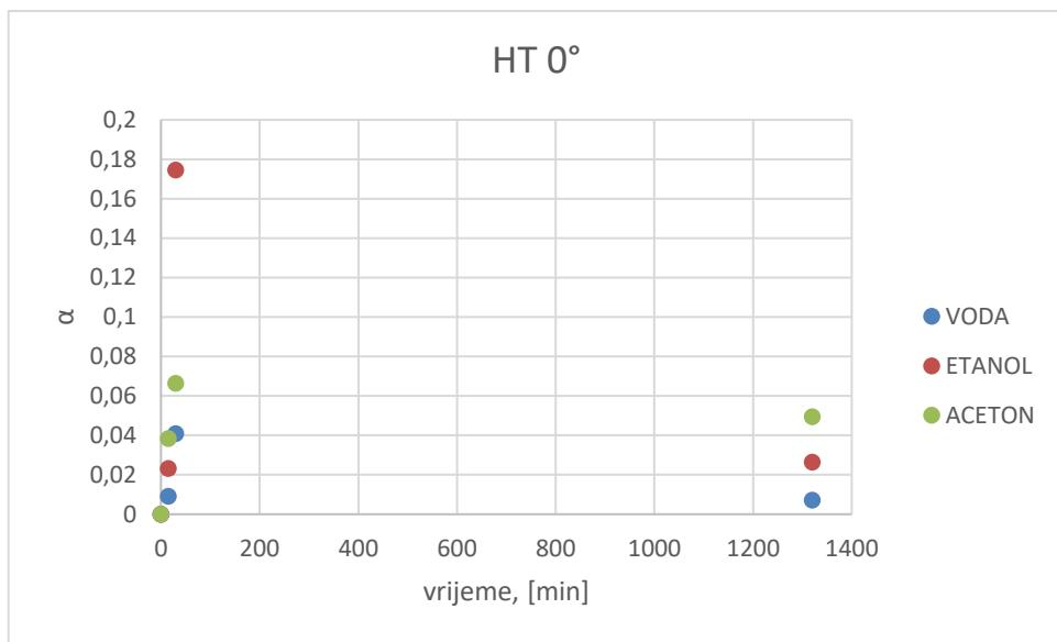
Slika 33. Grafički prikaz ovisnosti stupnja bubrenja (u otapalima vodi, etanolu i acetonu) o vremenu za epruvetu ispisano pod  $0^\circ$  (bez naknadnog očvršćivanja)
