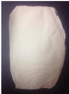
Slika 9. Fotografija vlaknastog mata dobivenog elektropredenjem
