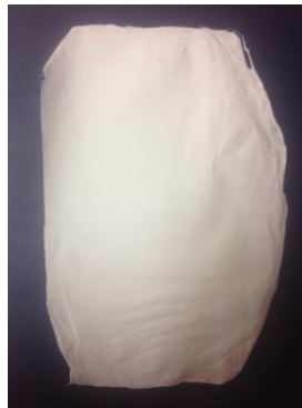
Slika 9. Fotografija vlaknastog mata dobivenog elektropredenjem
