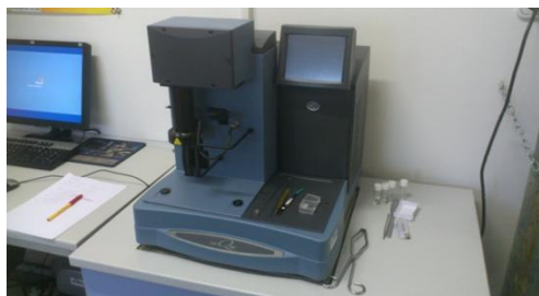
Slika 11. TGA analizator Q500, TA Instruments
