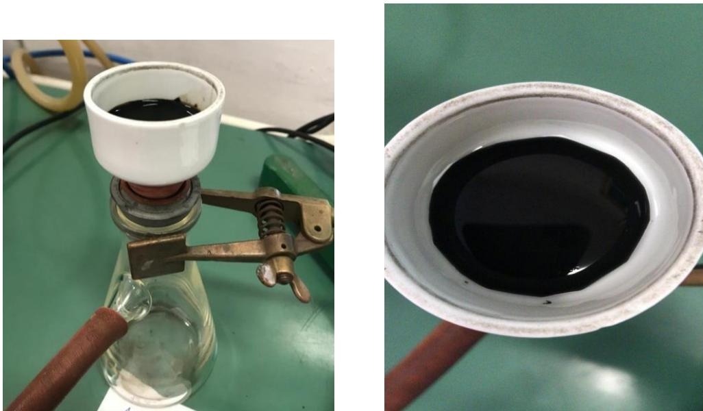
Slika 3.3. Vakuum filtracija
