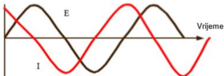
Slika 2.13. AC (izmjenična struja) val za narinuti potencijal, E i rezultirajuću struju, I.
