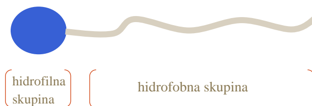
Slika 1. Shematski prikaz strukture PAT
