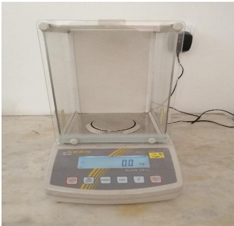
Slika 8: Analitička vaga KERN 220-04 (Zavod za anorgansku kemijsku tehnologiju i nemetale)
