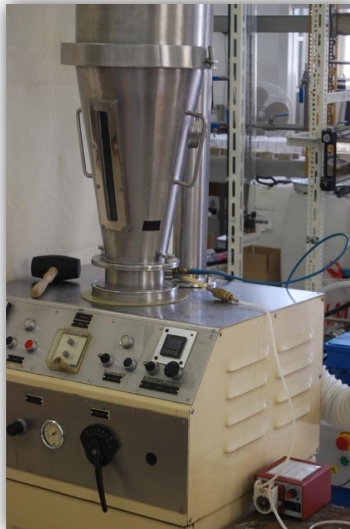
Slika 3.2. Fotografija granulatora s fluidiziranim slojem Uni-Glatt (Glatt GmbH, Binzen, Njemačka).
