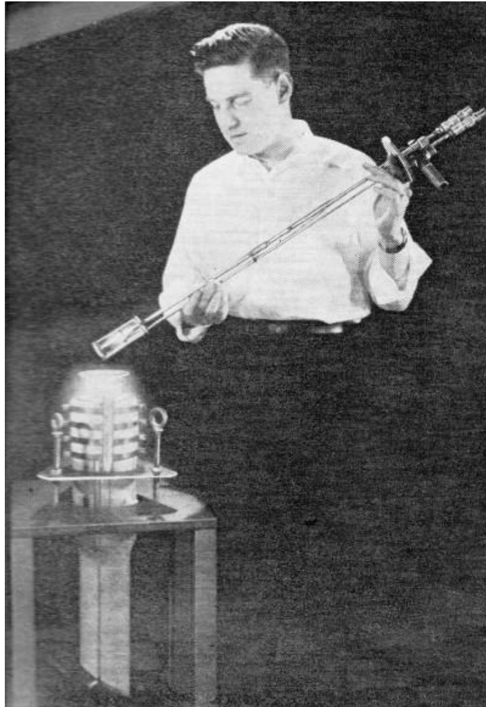
Slika 14. Dr. R. H. Kingston priprema maser za promatranje Venere u M.I.T. Lincoln laboratoriju u Millstone Hill zvjezdarnici.
