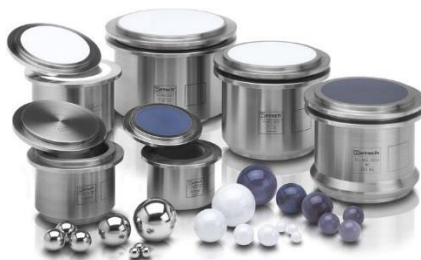
Slika 2.5. Razne izvedbe metalnih reakcijskih posudica i kuglica različitog polumjera i materijala [24]
