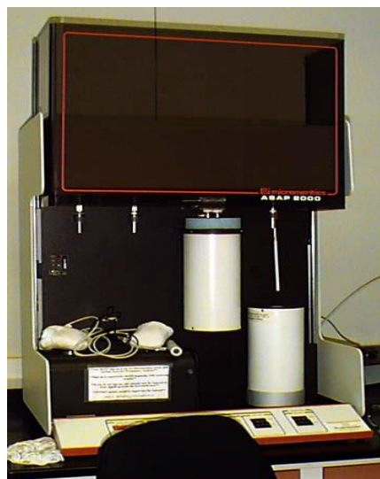
Slika 3.25. Uređaj za određivanje veličina pora, ASAP 2000 ( Micromeritics, SAD )
