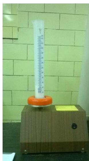
*Slika 3.14.* Uređaj za mjerenje gustoće nakon potresanja
