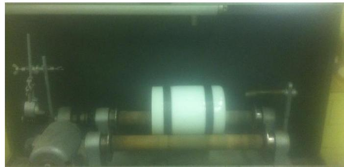
Slika 3.18. Kuglični mlin
