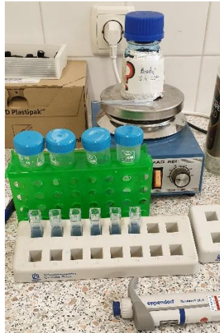
Slika 3.16. Određivanje koncentracije proteina metodom po Bradfordu
