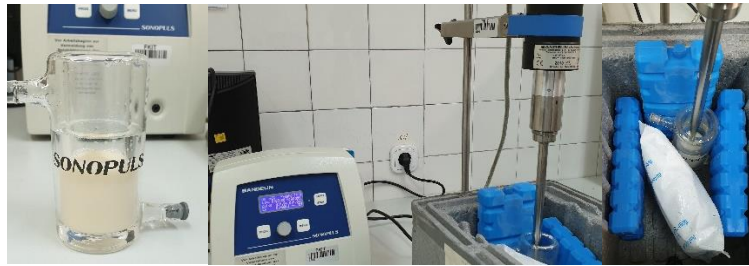
Slika 3.5. Aparatura za sonifikaciju
