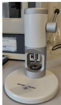
Slika 19. Preša za pripravu uzoraka
