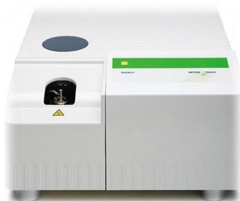
**Slika 4.4.** Fotografija diferencijalnog pretražnog kalorimetra Mettler Toledo 822e
