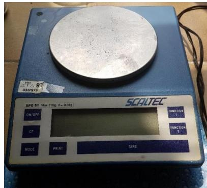
**Slika 3.3.** Tehnička vaga Scaltec SP0 51 [27]
