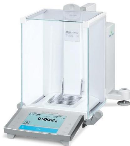
Slika 3.2. Analitička vaga Mettler Toledo XA105DU [26]
