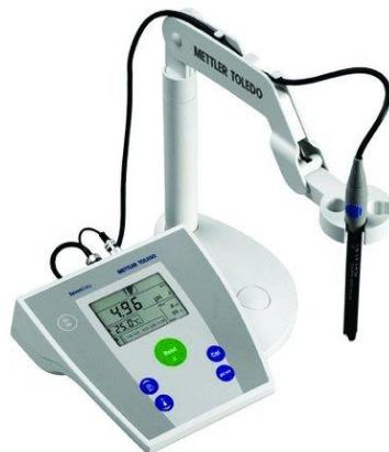
**Slika 3.4.** pH metar Mettler Toledo S20 SevenEasy [28]
