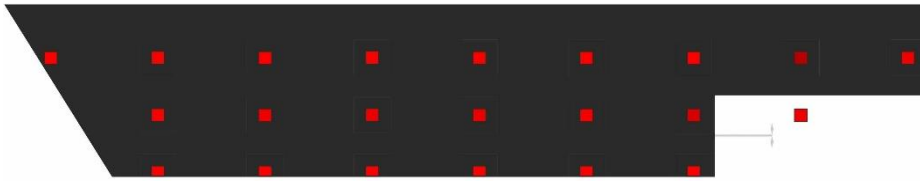
Slika 41. Prikaz raspodjele potencijala na brodu u bočatoj vodi bez strujanja fluida i bez ICCP sustava (7)
