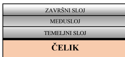
Slika 15. Shematski prikaz broskog premaza
