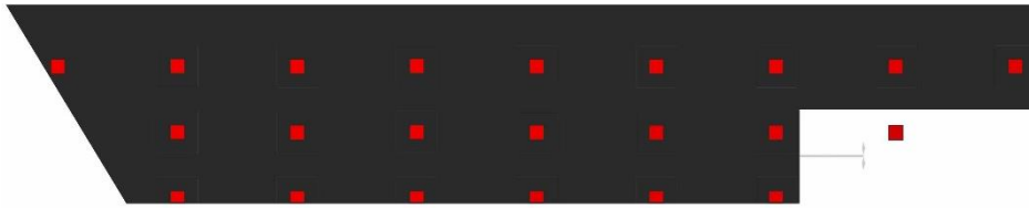
Slika 47. Prikaz raspodjele potencijala na brodu u slanoj vodi bez strujanja fluida i bez ICCP sustava (13)
