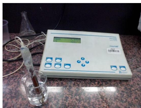
Slika 25. Određivanje pH-vrijednosti iona uzoraka pomoću pH-metra
