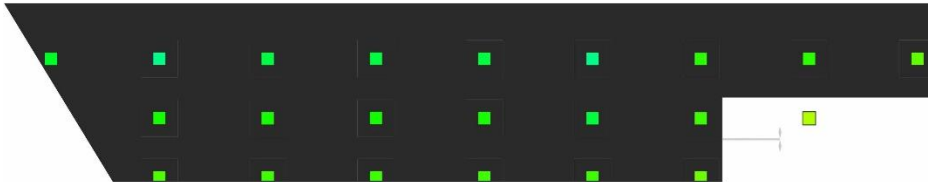
Slika 42. Prikaz raspodjele potencijala na brodu u bočatoj vodi bez strujanja fluida kada su uključene anode sa strane (8)
