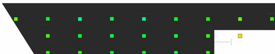
Slika 37. Prikaz raspodjele potencijala na brodu u slatkoj vodi bez strujanja fluida kada je uključena samo donja anoda (3)
