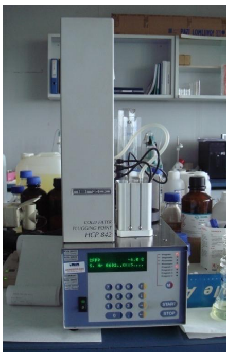
Slika 7. Automatski analizator za određivanje točke filtrabilnosti (Herzog HCP 842)
