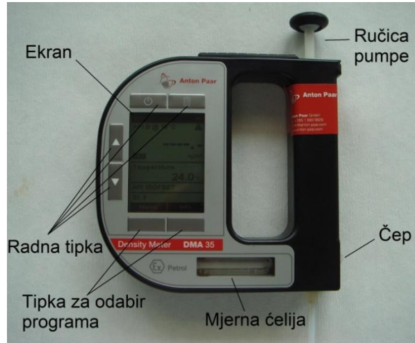
Slika 6. Denzitometar Anton Paar DMA 35 Ex Petrol
