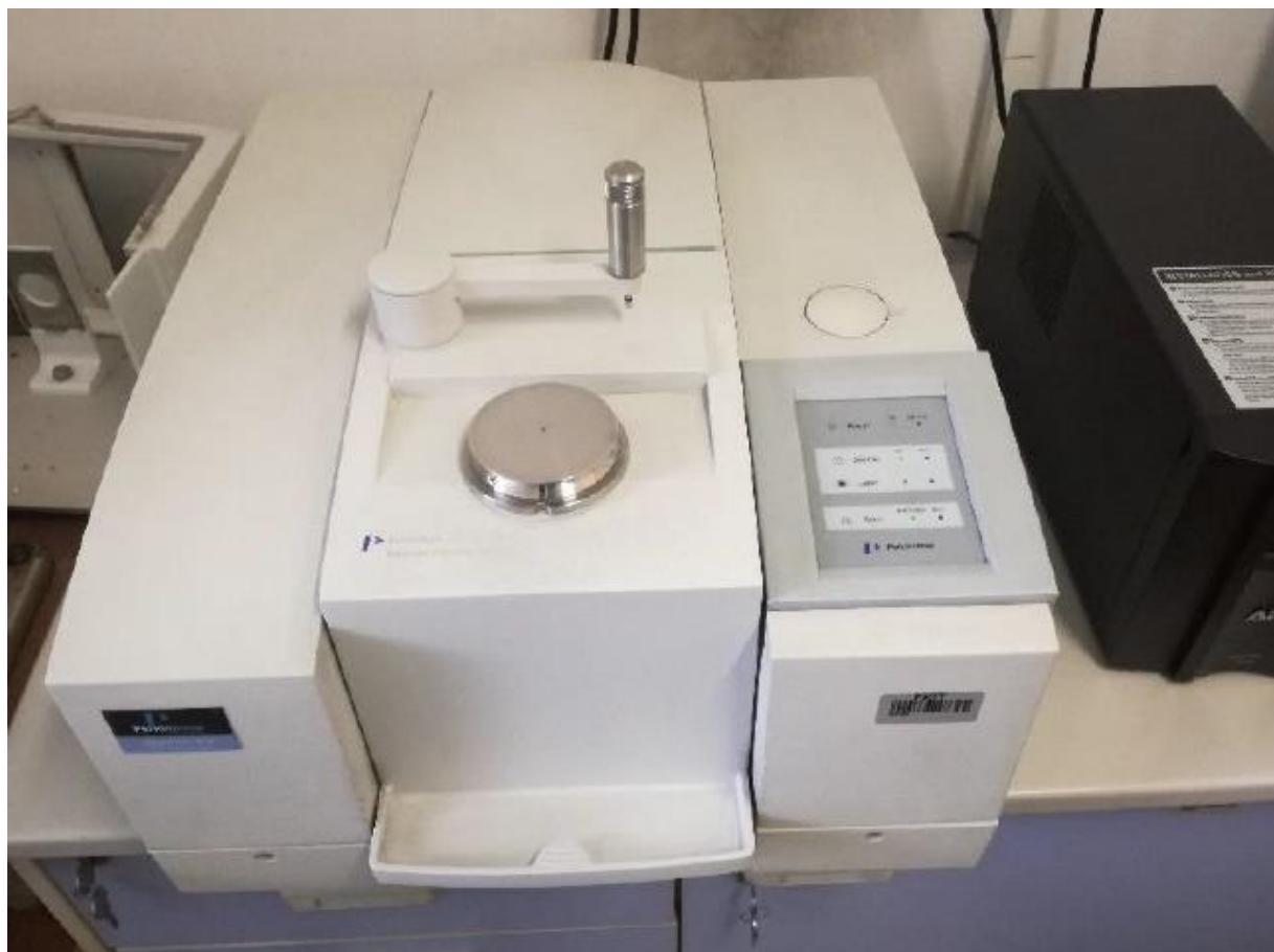
Slika 13. PerkinElmer Spectrum One korišten za analizu
