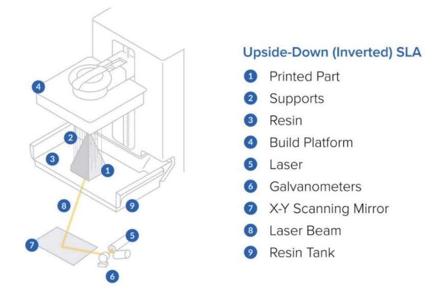
Slika 1. Princip rada SLA pisač
