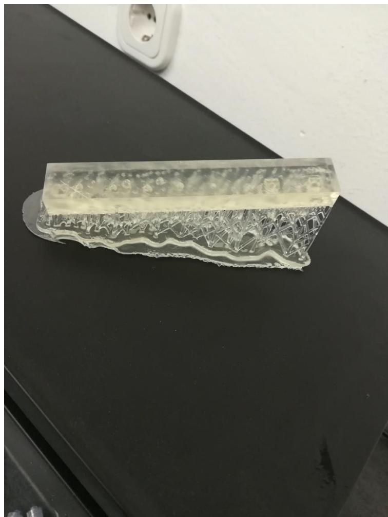
Slika 16. Milireaktor V2 s potpornim stupovima
