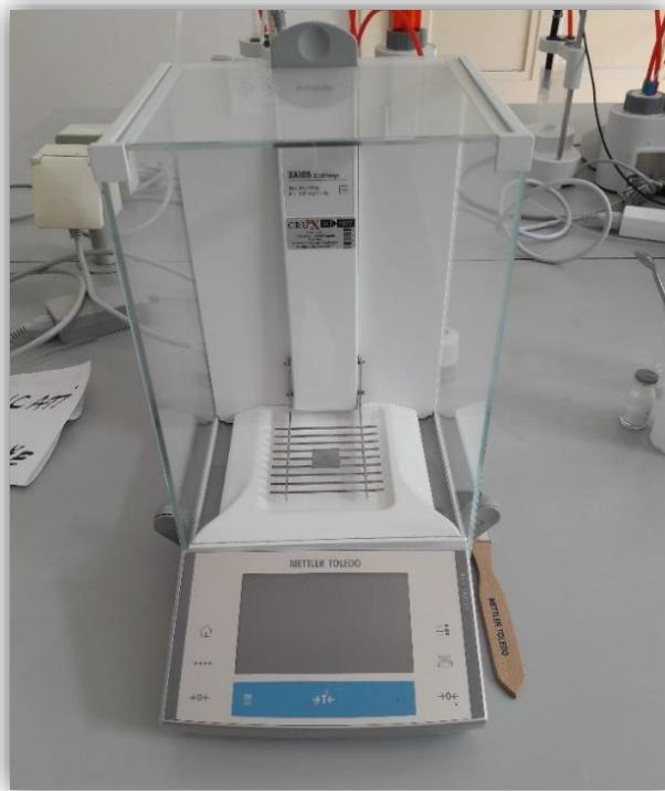
*Slika 9.: Analitička vaga Mettler Toledo XA105DU Dual-Range*
