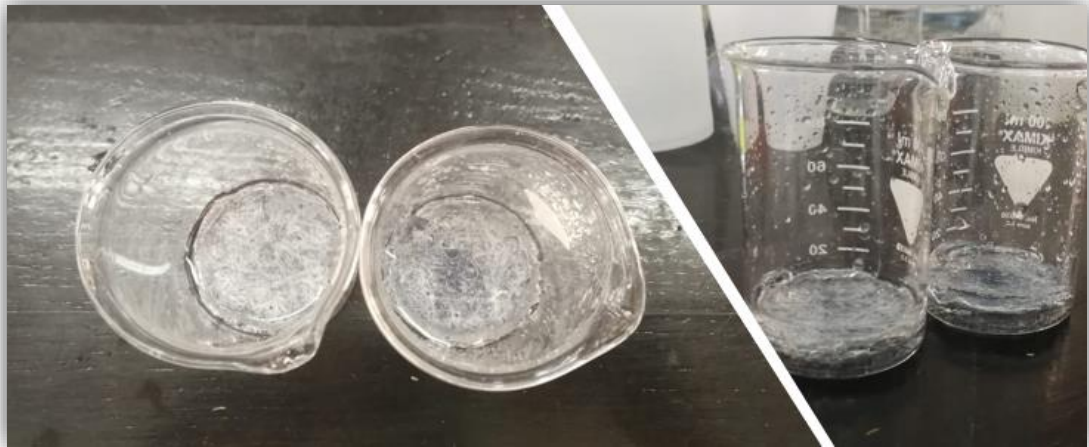
Slika 8.: Staklene mrežice s imobiliziranim \text{TiO}_2 i CNT
