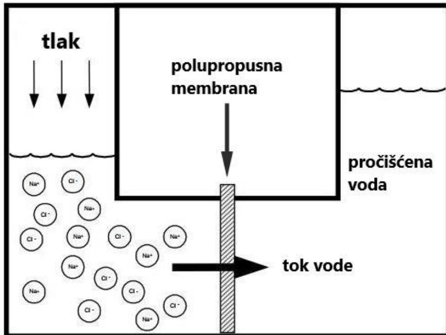
**Slika 5.** Jednostavan shematski prikaz reverzne osmoze [4].
