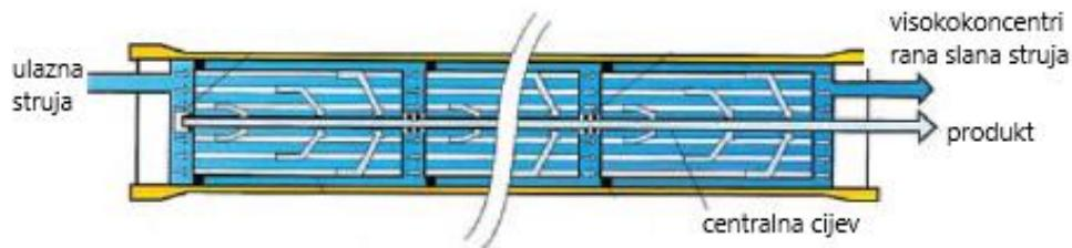
**Slika 12.** Struktura spiralnog modula i popratnih elemenata [9].
