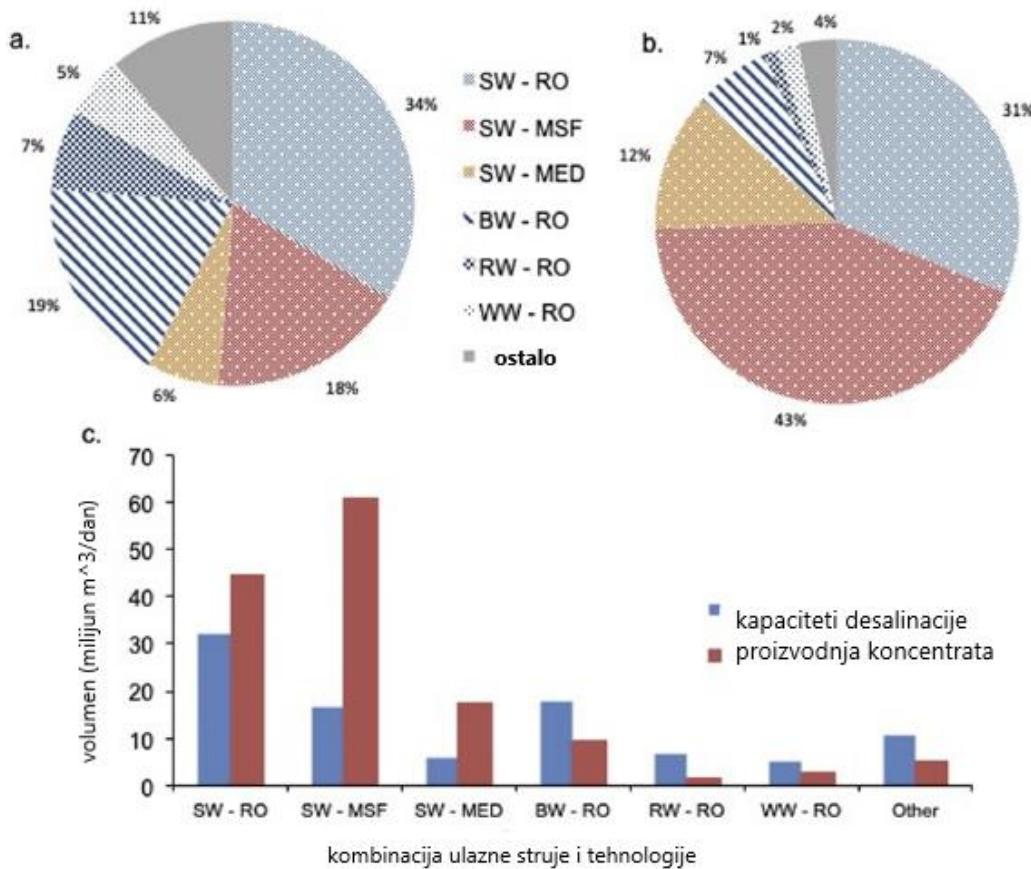
**Slika 4.** Glavne kombinacije tipa ulazne struje i tehnologije prema: a. globalnom udjelu u proizvodnji desalinirane vode (%), b. globalnom udjelu u proizvodnji slanice (%), c. ukupnom kapacitetu proizvodnje desalinirane vode i volumenu proizvedene slanice (milijun  $m^3/dan$ ) [10].
