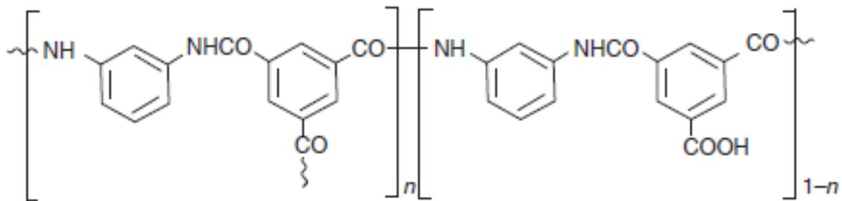
**Slika 11.** Struktura tipičnog materijala RO membrane (aromatski poliamid unakrsne strukture) [9].
