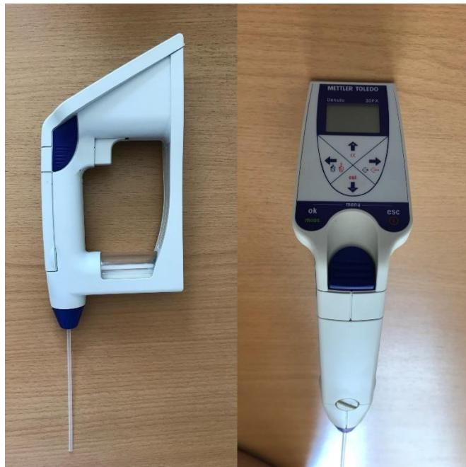
Slika 7. Uređaj za mjerjenje gustoće *Mettler Toledo Densitometer 30PX*.
