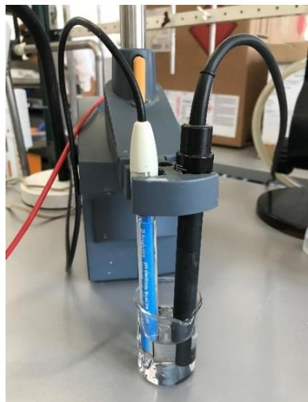
Slika 9. pH elektroda *BlueLine* (lijevo) i konduktometrijska elektroda *WTW Tetracon 325* (desno).
