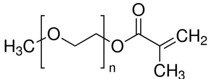
Slika 4. Struktura poli(etilenglikol)metileter-metakrilata
