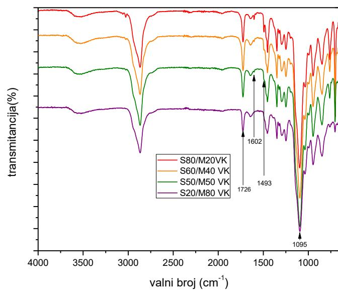
Slika 9. FTIR spektri za kopolimere do visokih konverzija
