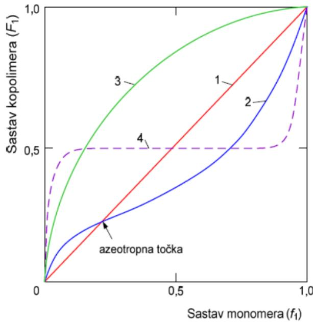
Slika 1. vrste kopolimerizacije: 1) idealna 2) azeotropna 3) simetrična 4) alternirajuća
