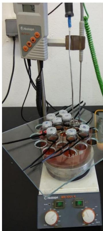
Slika 6. Istovremena provedba više polimerizacijskih reakcija u kupelji
