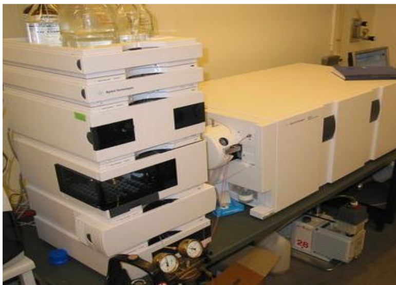
Slika 15. Agilent kromatografski sustav Series 1200 sa spektrometrom masa 6410 QqQ
