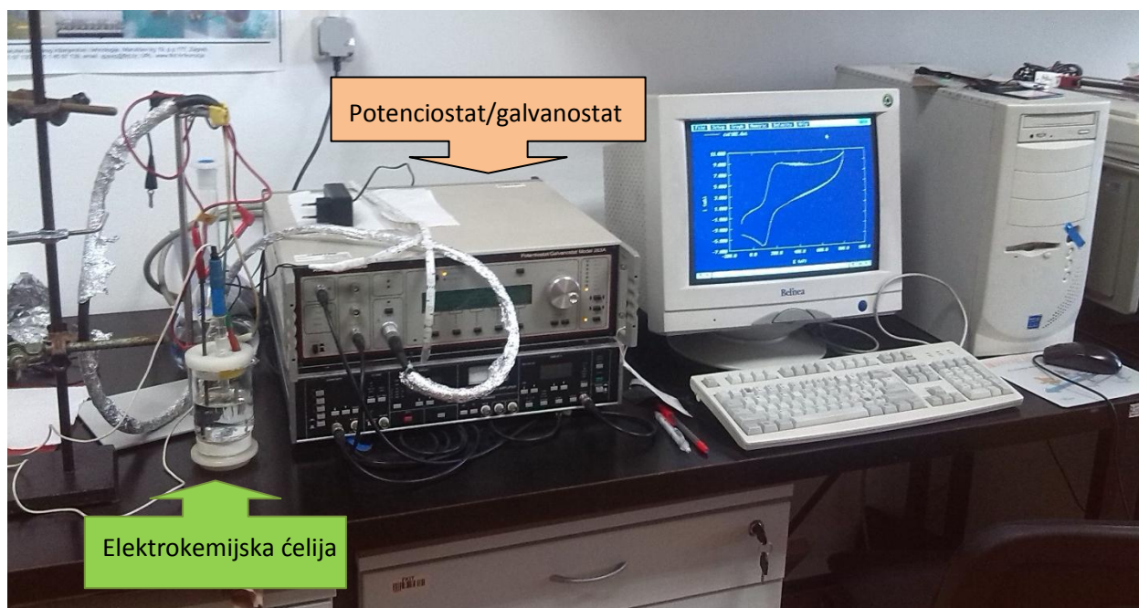
Slika 3.2. Aparatura korištena za elektrokemijska mjerenja
