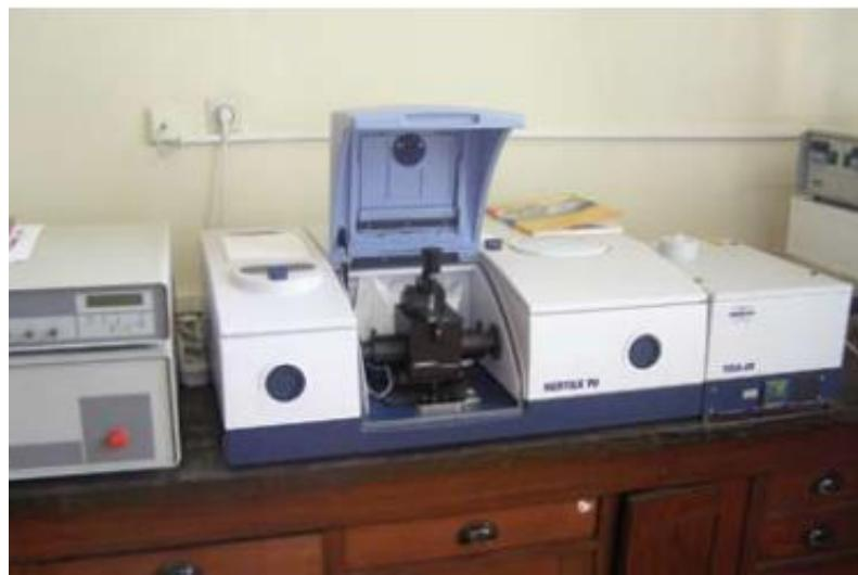
**Slika 17.** Infracrveni spektrofotometar s Fourierovom transformacijom signala *Bruker Vertex 70*, ZAKTN, FKIT
