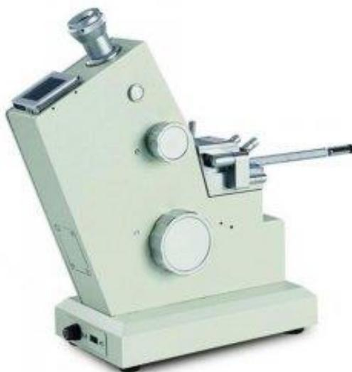
**Slika 16.** Refraktometar, *Exacta Optech RMI Abbe refractometer*
