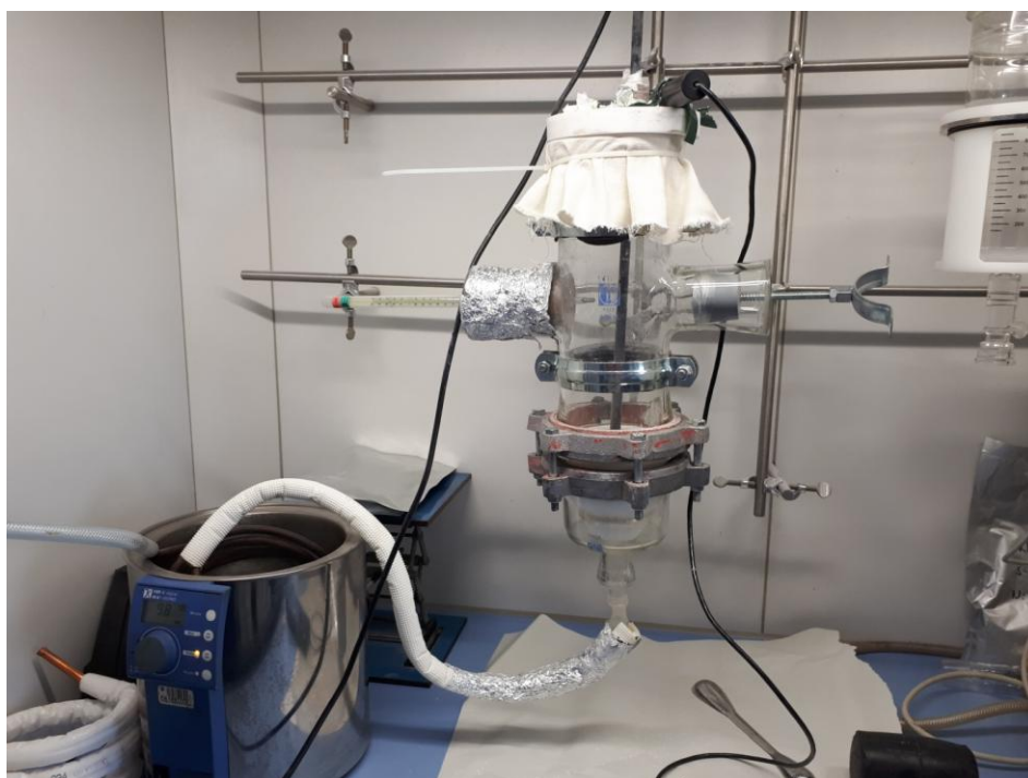
Slika 15. Sušionik s fluidiziranim slojem
