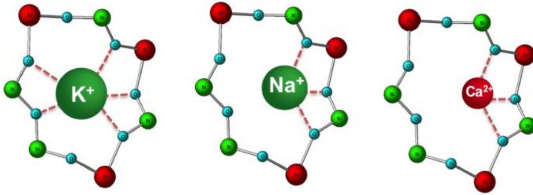
Slika 10. Prikaz vezanja kalijevog, natrijevog i kalcijevog iona u ciklosilikatnoj šupljini
