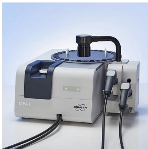
Slika 16. Uređaj za snimanje spektra, Bruker
