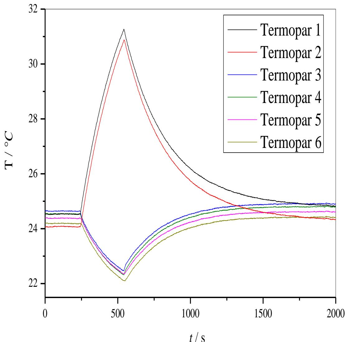
**Slika 24.** Prikaz promjene temperature metalnog valjka bez korištenja termovodljive paste na različitim udaljenostima od pobude Peltierovog elementa za električnu struju jakosti 0,5 A u trajanju od 5 min
