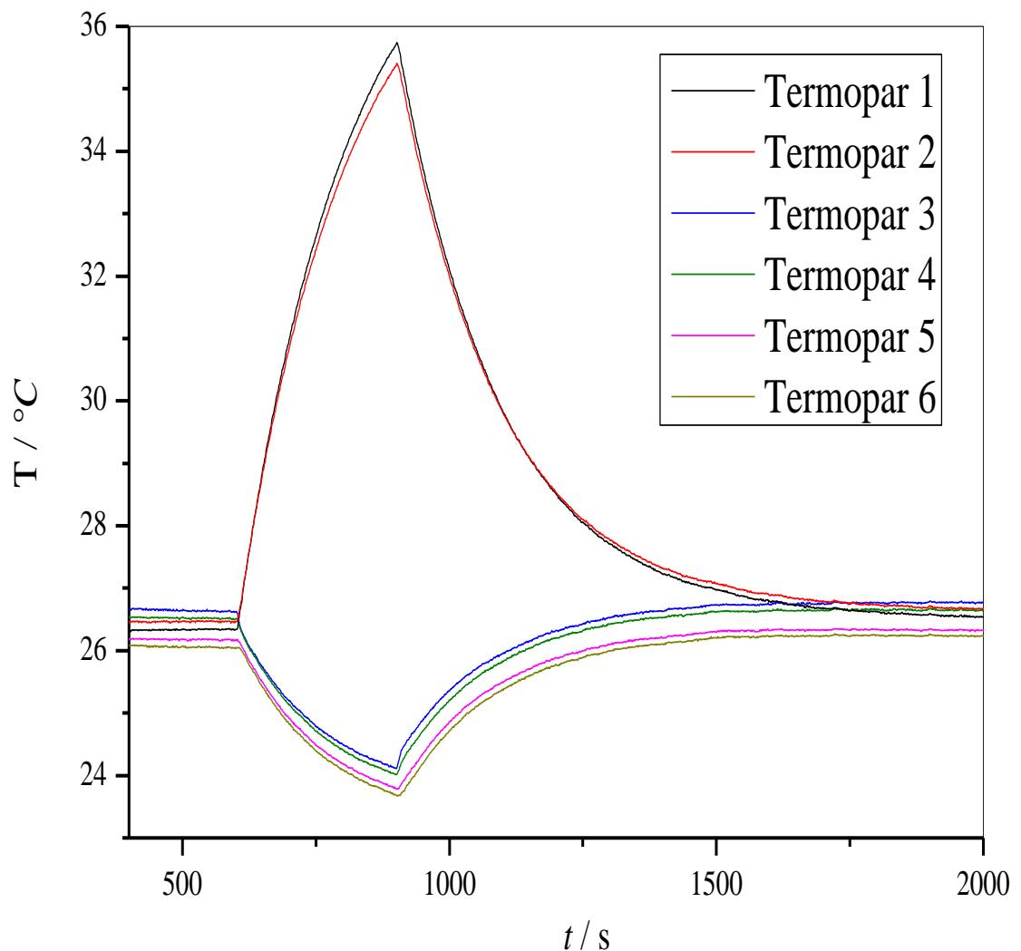
**Slika 20.** Prikaz promjene temperature metalnih valjaka s korištenjem termovodljive paste na različitim udaljenostima od pobude Peltierovog elementa za električnu struju jakosti 0,5 A u trajanju od 5 min
