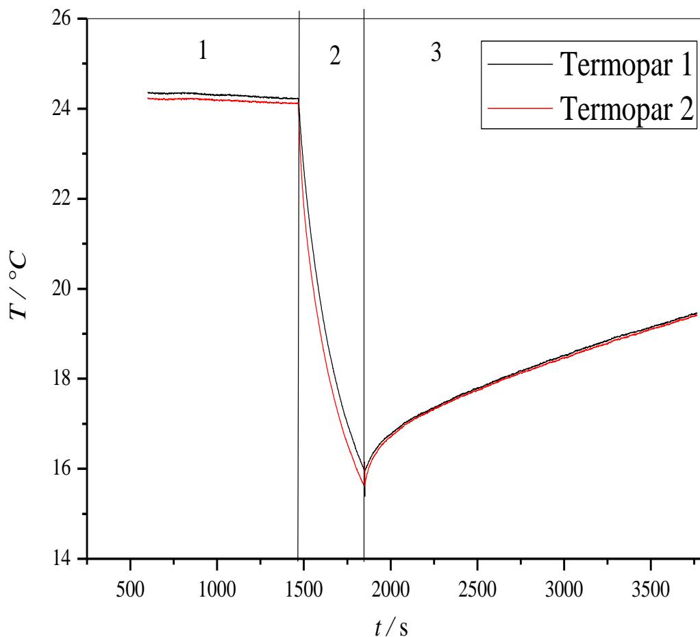
**Slika 16.** Prikaz mjerjenja odziva dva tanja termopara koja se nalaze u istoj rupi metalnog valjka koji je podvrgnut hlađenju
