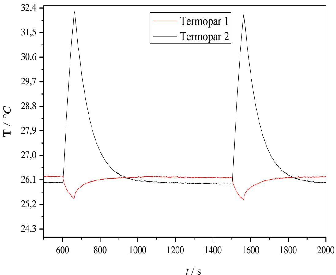
**Slika 28.** Prikaz rezultata mjerjenja ovisnosti temperature o vremenu u slučaju hlađenja metalnog valjka debljine 50.0 mm i grijanja metalnog valjka debljine 5.0 mm
