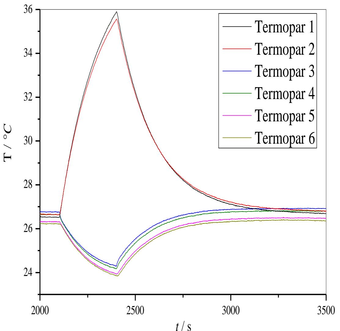
**Slika 21.** Prikaz promjene temperature metalnih valjaka s korištenjem termovodljive paste na različitim udaljenostima od pobude Peltierovog elementa za električnu struju jakosti 0,5 A u trajanju od 5 min neposredno nakon mjerjenje u istim uvjetima
