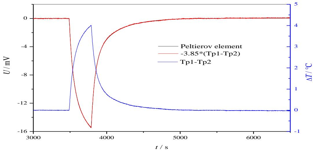
**Slika 31.** Ovisnost napona Peltierovog elementa između metalnih valjaka 1 i 2, sa pripadnom razlikom temperatura metalnih valjaka 1 i 2 (uz sliku 29 i 30).
