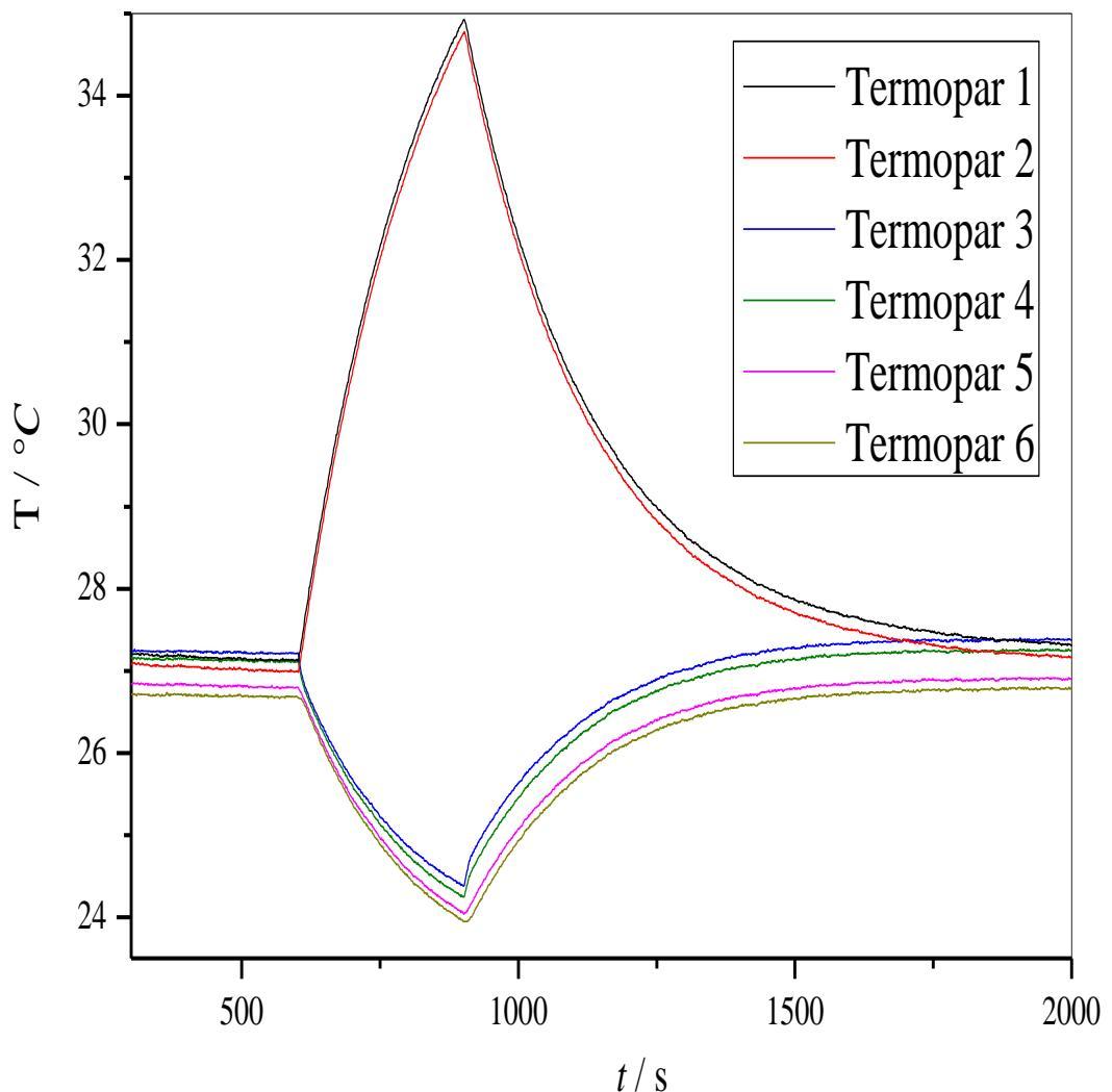
**Slika 25.** Prikaz promjene temperature metalnog valjka s korištenjem termovodljive paste na različitim udaljenostima od pobude Peltierovog elementa za električnu struju jakosti 0,5 A u trajanju od 5 min
