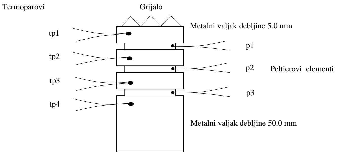
**Slika 9.** Shematski prikaz mjerjenja
