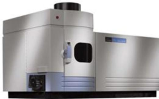
Slika 18. ICP-OES spektrometar, Perkin Elmer, Optima 2000 DV
