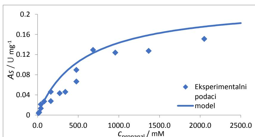
**Slika 5.1** Ovisnost početne reakcijske brzine redukcije propanala o koncentraciji propanala ( $T = 25^\circ\text{C}$ ,  $c_{\text{fosfatni pufer}} = 100 \text{ mM}$ ,  $\text{pH} = 8$ ,  $\gamma_{\text{enzim}} = 1,0 \text{ mg/mL}$ ,  $c_{\text{NADPH}} = 0,1 \text{ mM}$ ,  $c_{\text{propanal}} = 13,7\text{--}2734,2 \text{ mM}$ )
