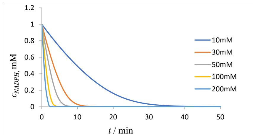
**Slika 5.12.** Prikaz pada koncentracije NADPH u ovisnosti o vremenu tijekom redukcije za različite koncentracije propanala ( $c_{\text{NADPH}} = 1 \text{ mM}$ ;  $\gamma_{\text{KRED}} = 10 \text{ mg cm}^{-3}$ )
