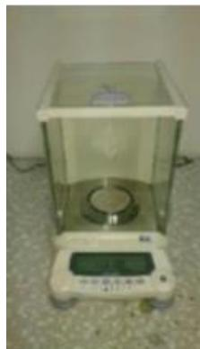
**Slika 3.1** Analitička vaga *Shimadzu*
