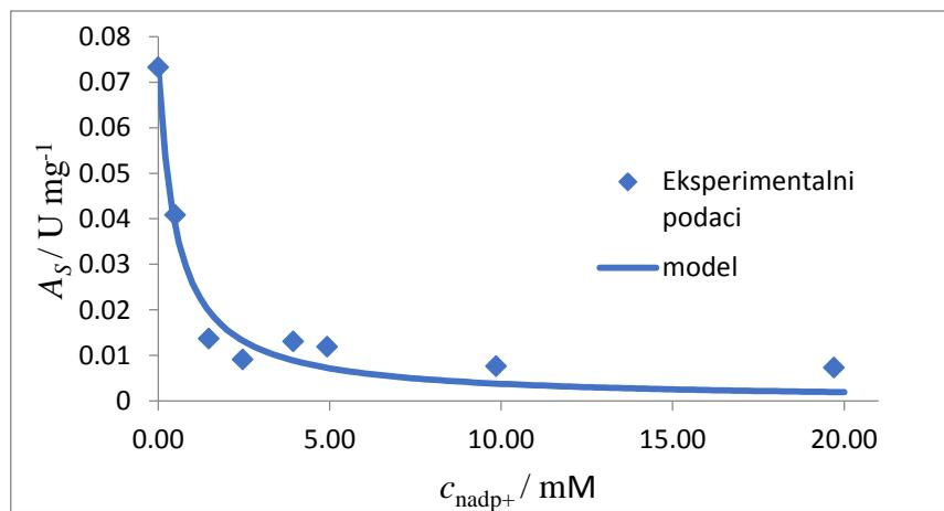
**Slika 5.4.** Ovisnost početne reakcijske brzine redukcije propanala o koncentraciji NADP<sup>+</sup> ( $T = 25^\circ\text{C}$ ,  $c_{\text{fosfatni pufer}} = 100 \text{ mM}$ ,  $\text{pH} = 8$ ,  $\gamma_{\text{enzim}} = 1,0 \text{ mg/mL}$ ,  $c_{\text{NADPH}} = 0,035 \text{ mM}$ ,  $c_{\text{propanal}} = 683,5 \text{ mM}$ ,  $c_{\text{NADP}^+} = 0-19,71 \text{ mM}$ )
