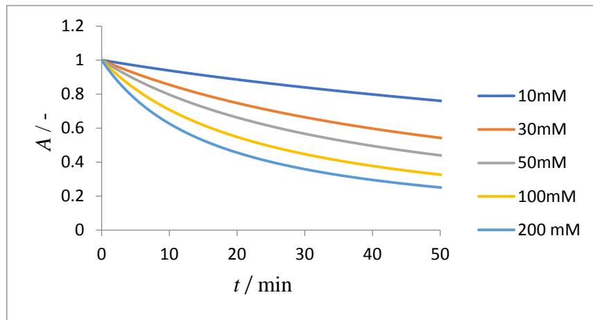
**Slika 5.11.** Prikaz pada aktivnosti enzima tokom vremena za uzorke s različitim početnim koncentracijama propanala ( $c_{\text{NADPH}} = 1 \text{ mM}$ ;  $\gamma_{\text{KRED}} = 10 \text{ mg cm}^{-3}$ )
