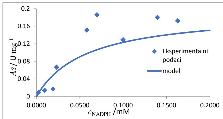
**Slika 5.2.** Ovisnost početne reakcijske brzine redukcije propanala o koncentraciji NADPH ( $T = 25^\circ\text{C}$ ,  $c_{\text{fosfatni pufer}} = 100 \text{ mM}$ ,  $\text{pH} = 8$ ,  $\gamma_{\text{enzim}} = 1,0 \text{ mg/mL}$ ,  $c_{\text{NADPH}} = 0,0024\text{-}0,1630 \text{ mM}$ ,  $c_{\text{propanal}} = 683,5 \text{ mM}$ )
