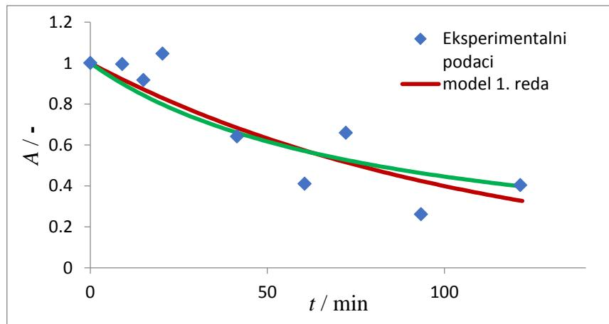
Slika 5.6. Operacijska stabilnost enzima pri koncentraciji propanala od 9,60 mM
