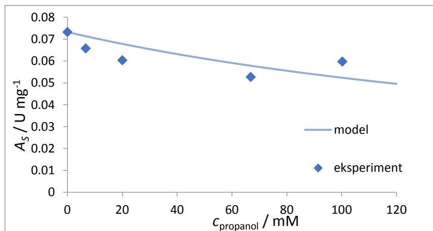
**Slika 5.3.** Ovisnost početne reakcijske brzine redukcije propanala o koncentraciji propanola ( $T = 25^\circ\text{C}$ ,  $c_{\text{fosfatni pufer}} = 100 \text{ mM}$ ,  $\text{pH} = 8$ ,  $\gamma_{\text{enzim}} = 1,0 \text{ mg/mL}$ ,  $c_{\text{NADPH}} = 0,035 \text{ mM}$ ,  $c_{\text{propanal}} = 683,5 \text{ mM}$ ,  $c_{\text{propanol}} = 0\text{-}669 \text{ mM}$ )
