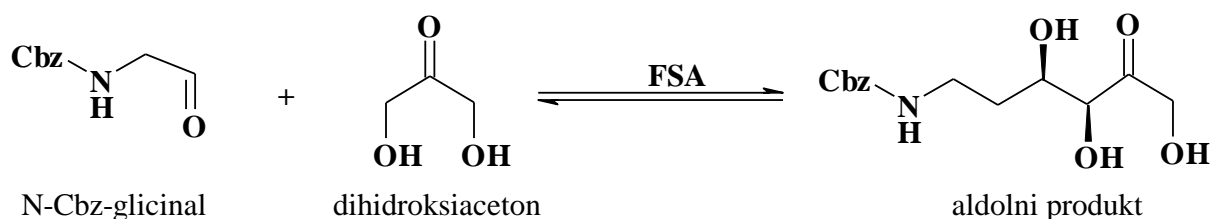
Slika 3.8. Reakcija aldolne adicije dihidroksiacetona na N-Cbz-glicinal
