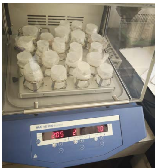
Slika 4.11. Fotografija laboratorijske inkubatorske tresilice IKA KS 3000 (IKA, Staufen, Savezna Republika Njemačka)
