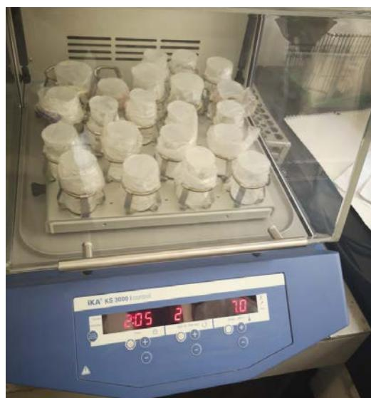
**Slika 4.11.** Fotografija laboratorijske inkubatorske tresilice IKA KS 3000
