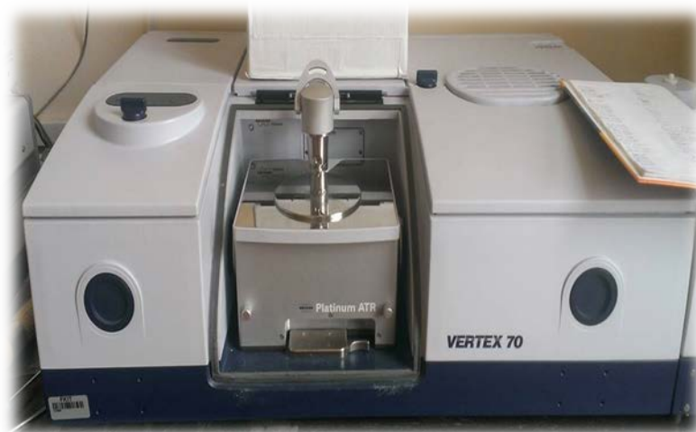
Slika 5.2. Fotografija FTIR spektrofotometra Bruker Vertex 60 s platinastim detektorom
