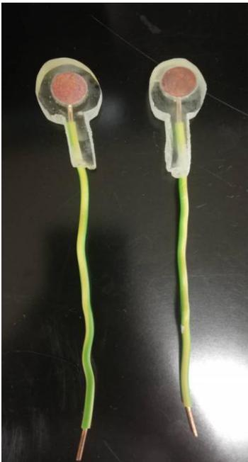
*Slika 6.* Prikaz radnih elektroda
