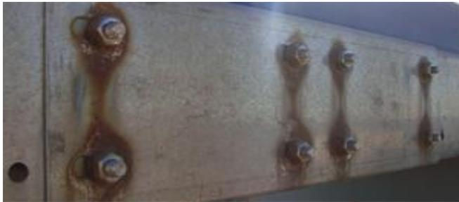
Slika 2. Galvanska (kontaktne) korozija [4]
