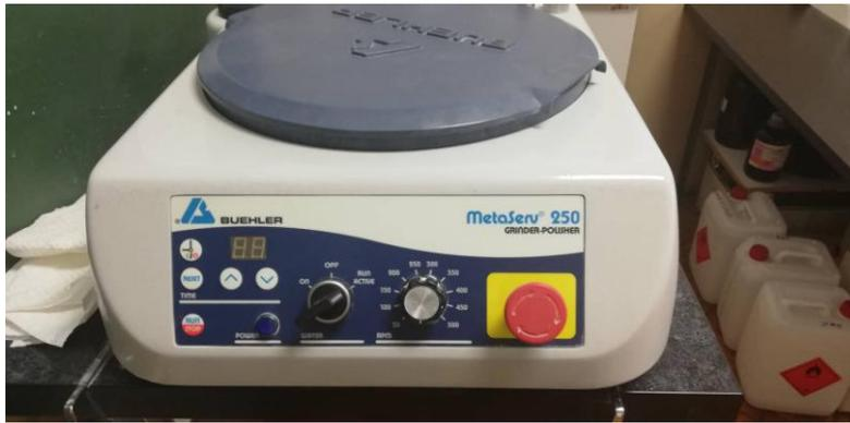
Slika 7. Uređaj za poliranje
