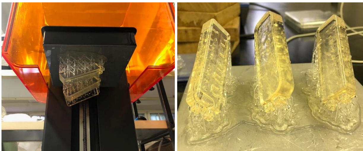
Slika 3.6. Modeli ispisani na 3D–pisaču
