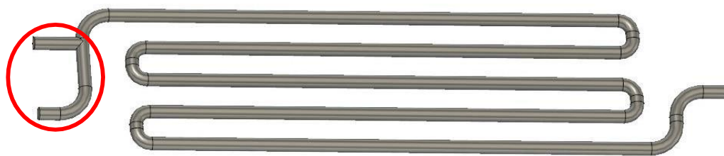
Slika 3.16. Cijevni reaktor sa označenim volumenom u kojemu se ne odvija reakcija 29
