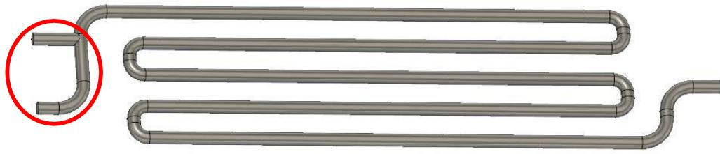
**Slika 3.16.** Cijevni reaktor sa označenim volumenom u kojemu se ne odvija reakcija<sup>29</sup>
