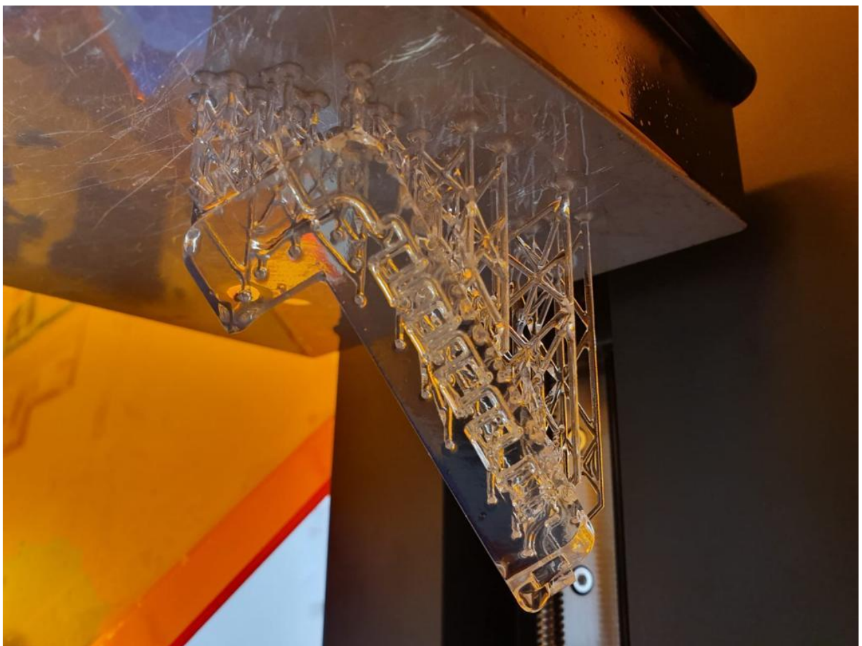
Slika 2.5. Milireaktor izrađen postupkom stereolitografije
