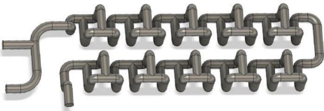
Slika 3.10. Cjevovod reaktora Mobius 10
