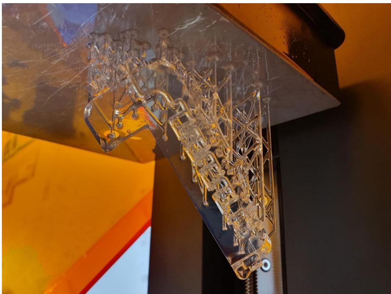
**Slika 2.5.** Milireaktor izrađen postupkom stereolitografije
