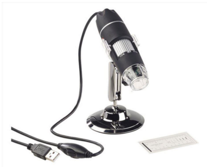
Slika 16. Digitalni mikroskop za određivanje širine mikrokanala
