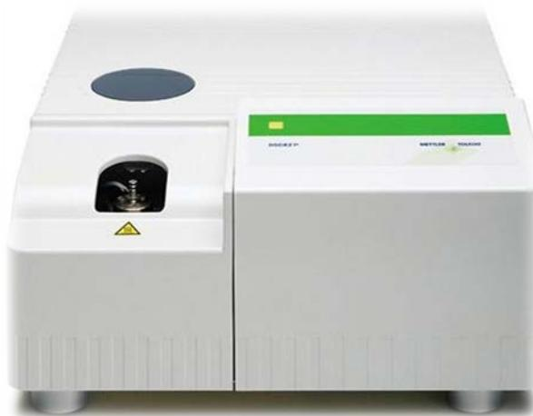
**Slika 3.5.** Fotografija diferencijalnog pretražnog kalorimetra Mettler Toledo 822<sup>e</sup>
