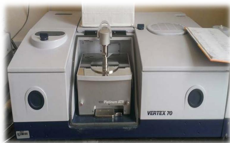
**Slika 3.8.** Fotografija FTIR spektrofotometra Vertex 70 s platinastim detektorm
