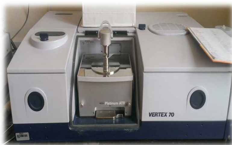
Slika 3.8. Fotografija FTIR spektrofotometra Vertex 70 s platinastim detektorom (Bruker, Billerica, SAD)
