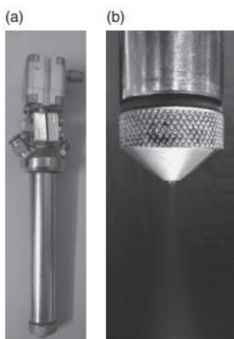
Slika 4. (a) Mlaznica atomizera s dva fluida, (b) raspršivanje iz mlaznice s dva fluida
