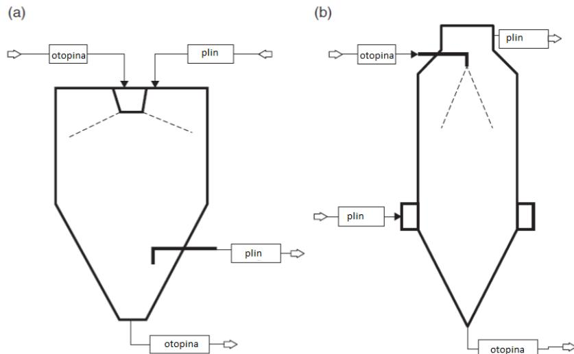
Slika 6. Tipovi sušionika: a) istostrujni kontakt; b) protustrujni kontakt
