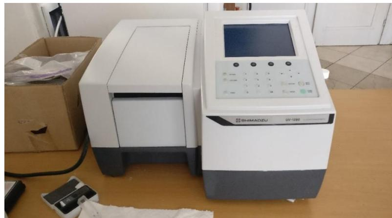
Slika 16. UV/Vis spektrofotometru Shimadzu UV-1280
