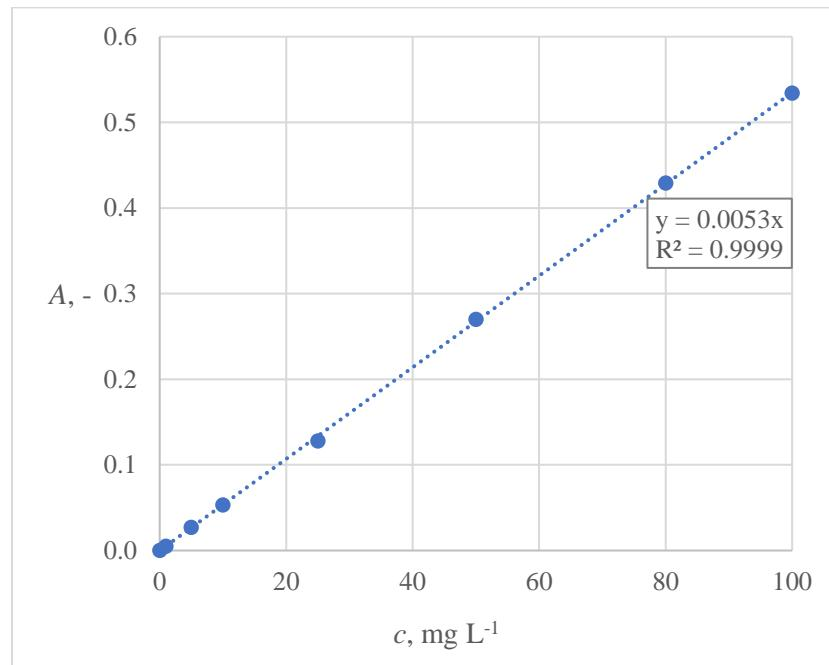
Slika 17. Umjerni pravac za celekoksib u ispitivanom mediju
