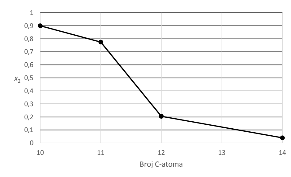
Slika 24. Ovisnost eutektičnoga sastava izraženoga molarnim udjelom n -alkana u sustavu o broju C-atoma
