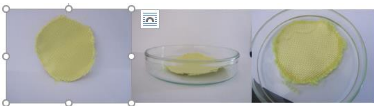
Slika 12. a) Aramidno vlakno korišteno za probni test b) Aramidno vlakno u petrijevoj zdjelici c) Uranjanje kevlara u 10 %-tni nanofluid
