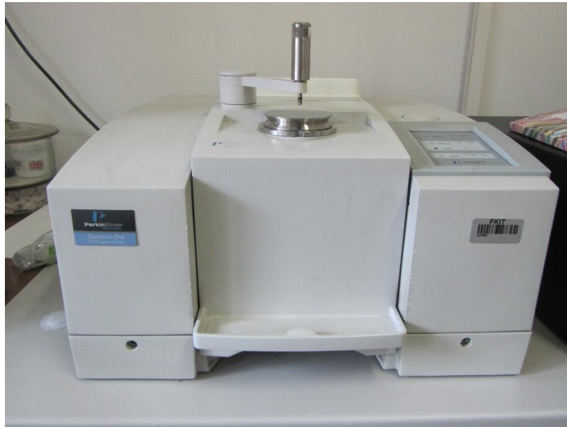
Slika 14. Instrument za infracrvenu spektroskopsku metodu
