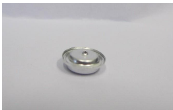
Slika 11. Posudica s poklopcem za uzorak za DSC mjerenja
