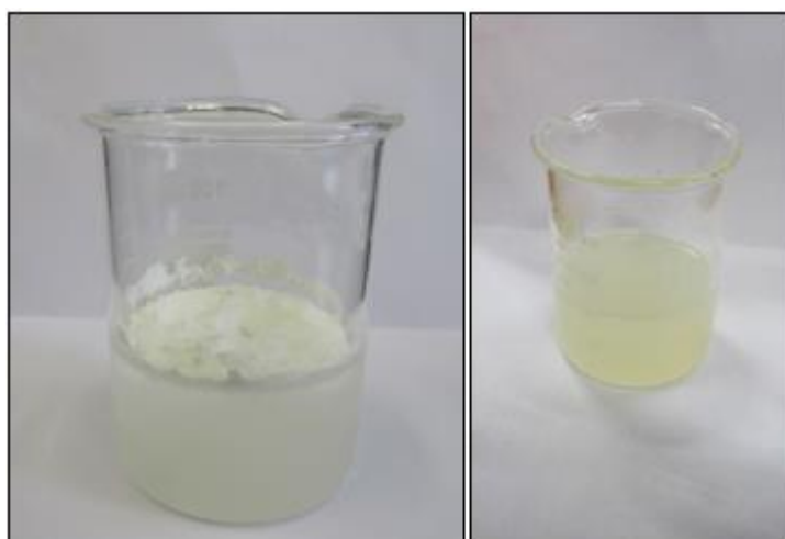
Slika 8. Smjesa prije mehaničkog miješanja (lijevo) i nakon homogenizacije (desno)
