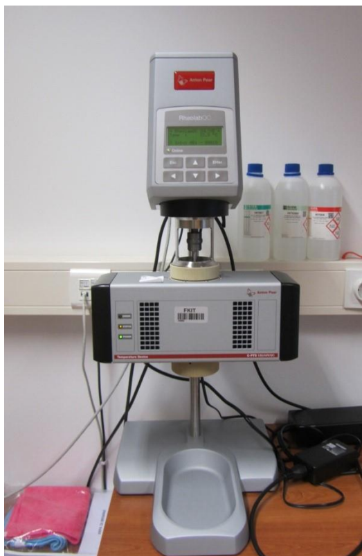
Slika 10. Reometar Anton Paar
