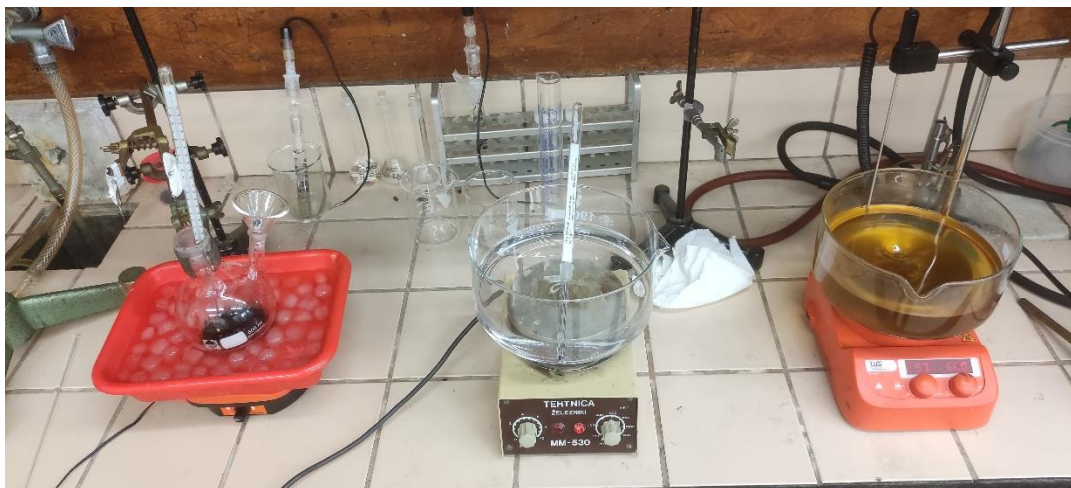
Slika 13. Postupak pripreme grafenovog oksida Hummersovom metodom (ledena, vodena i uljna kupelj)
