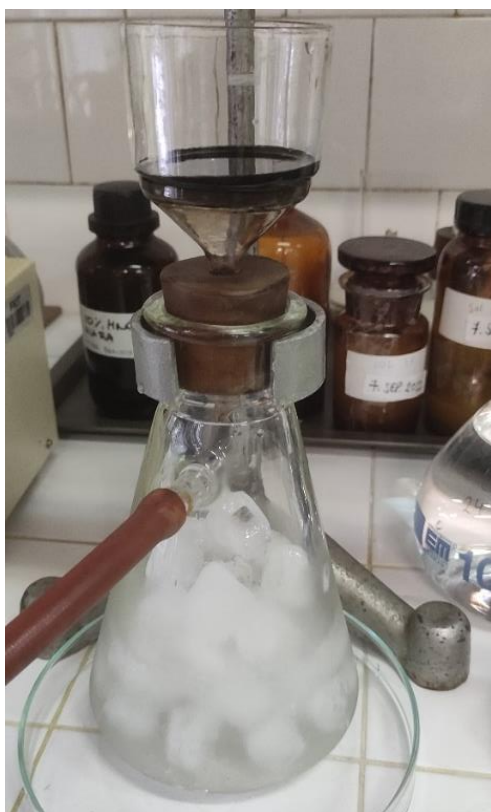
Slika 12. Filtriranje suspenzije interkaliranog grafita pomoću sinter lijevka
