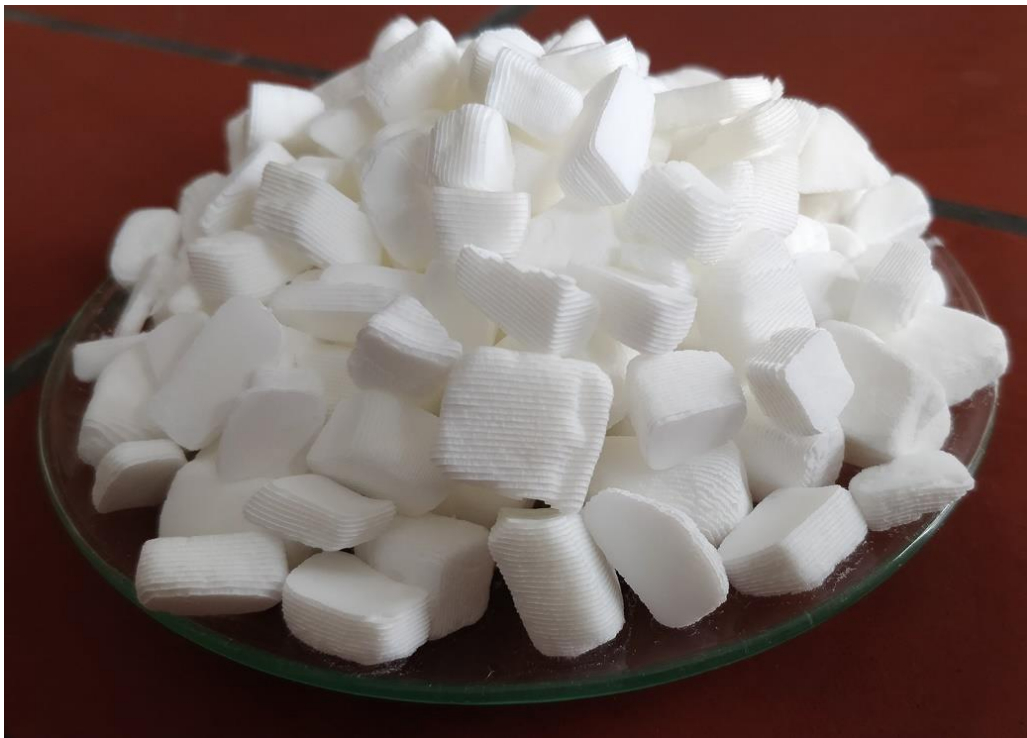
Slika 13. Kalcij-fosfatni nosači dobiveni hidrotermalnom sintezom sipine kosti.
