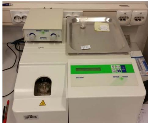
**Slika 13.** Diferencijalni pretražni kalorimetar, Mettler Toledo DSC 823e
