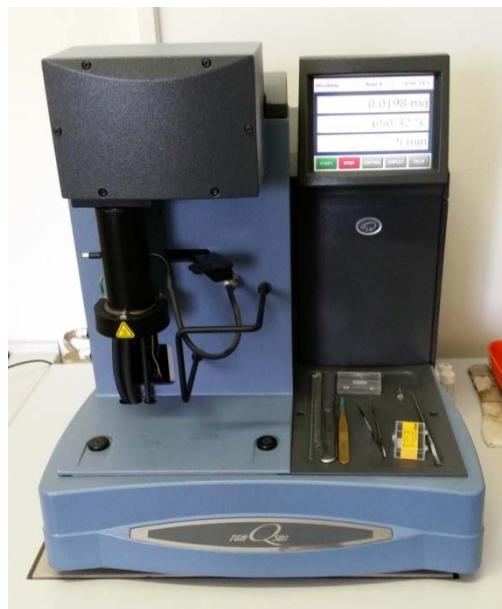
**Slika 14. Uređaj za termogravimetrijsku analizu, TA Instruments Q500**
