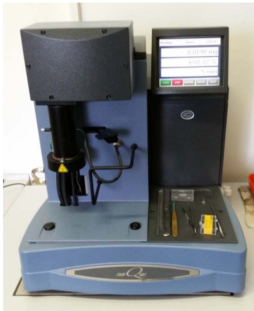
Slika 14. Uređaj za termogravimetrijsku analizu, TA Instruments Q500
