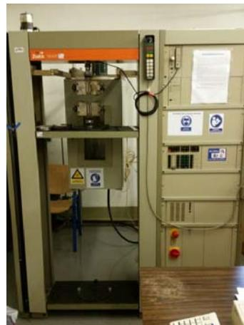
**Slika 15.** Stroj za mehanička ispitivanja, Zwick 1445
