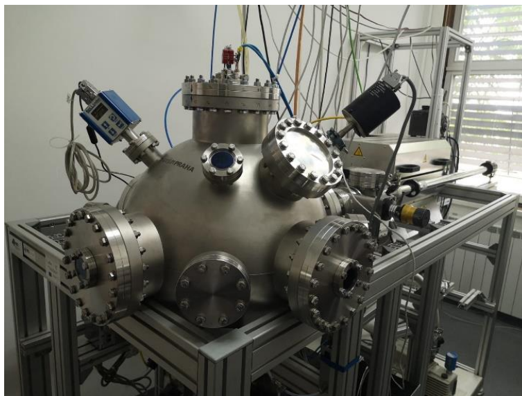
Slika 36. Vakuumska komora sustava za depoziciju tankih filmova magnetronskim rasprašivanjem.
