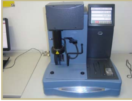
Slika 16. Termogravimetar, TA Instruments Q500
